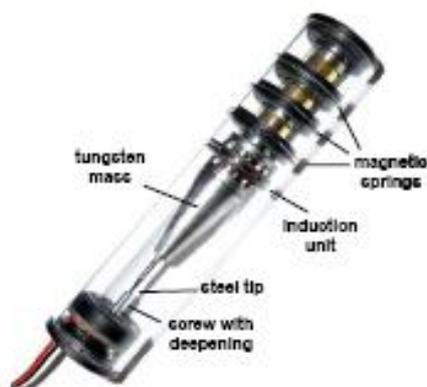
Figure I-38 : Générateur électromagnétique bidirectionnel [I-44]
