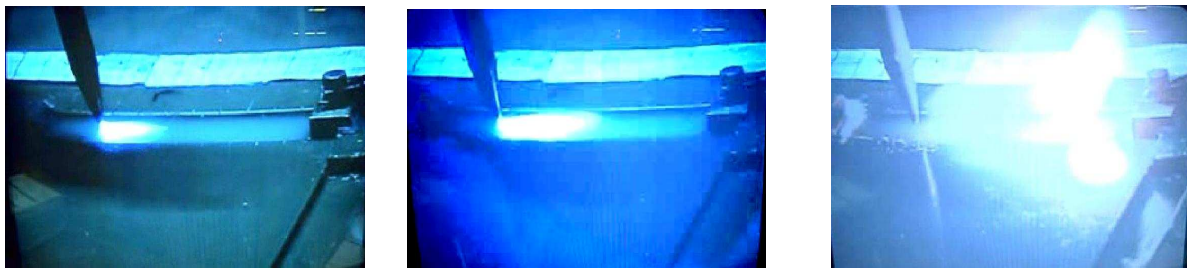
Figure III.2. Allongement de la décharge jusqu'au contournement.
