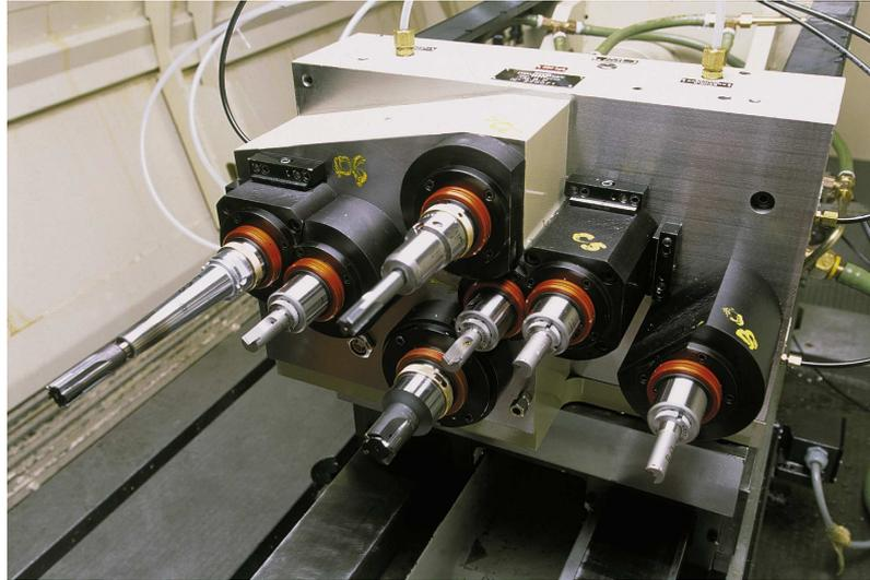
Figure 3.1 Boîtier d'usinage multi-broche (PCI/SCEMM)
