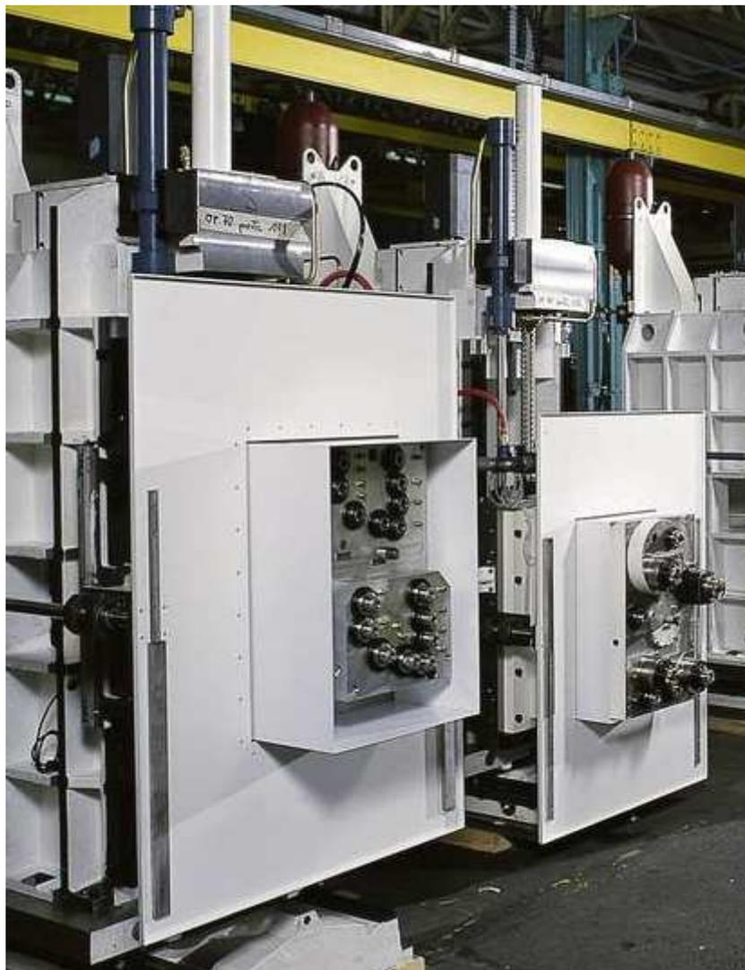
Figure 5.4 Machines spéciales – à boîtiers multi-broches
