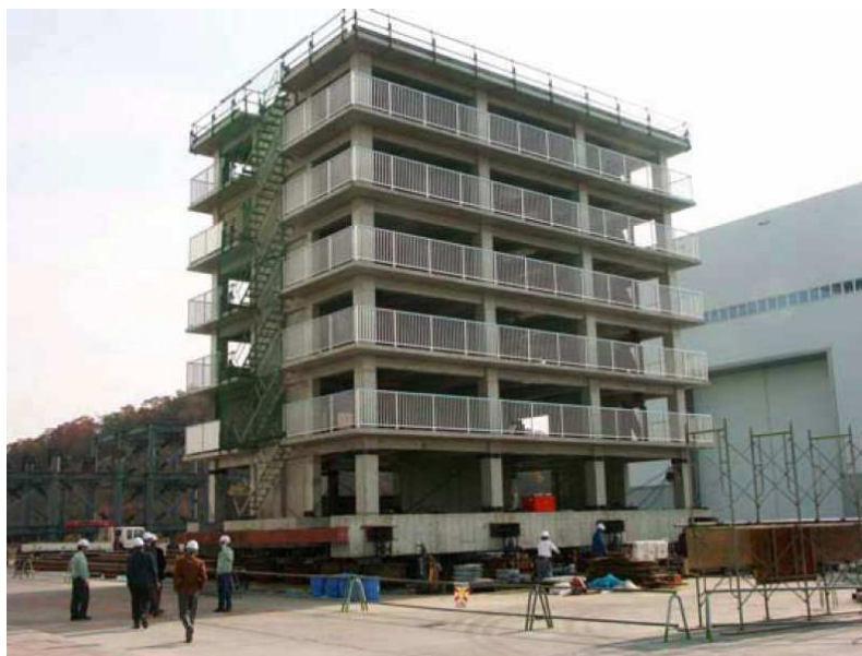
FIGURE 1.2: Exemple de structure réelle testée sur table vibrante (Miki) [Sollogoub, 2007]
