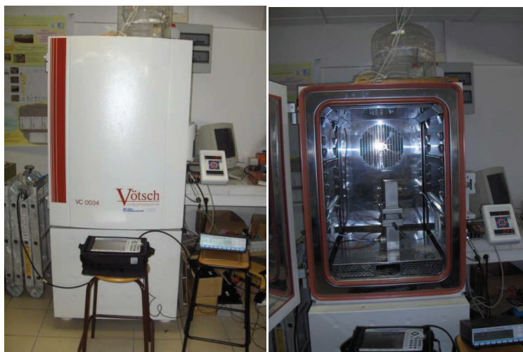
Figure 38 : Enceinte climatique (EGID)
