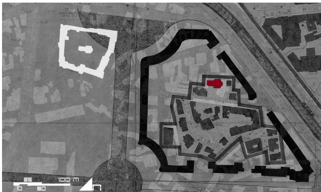
Figure 20 – Document planimétrique qui indique de situation de l'église Mihai Voda avant et après son déplacement. Par la superposition, on peut lire la situation initiale de l'église Mihai Voda avec son cloître (en blanc) et le nouvel emplacement, dissimulé derrière les immeubles communistes (en noir), au centre de l'îlot. (Crédit personnel)
