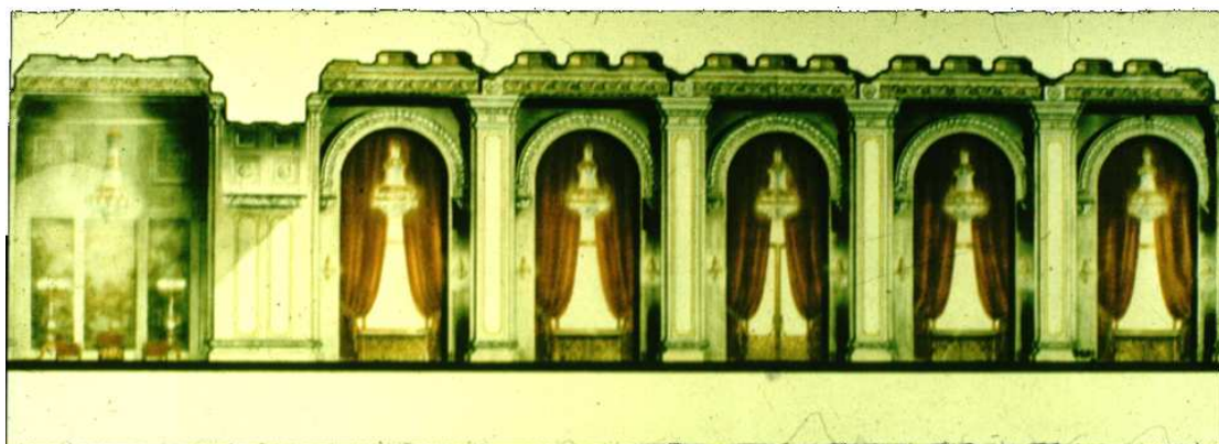
Figure 24 – Planche représentant une coupe de la salle I.C. Brateanu. Ce type de travail graphique permettait de dessiner tous les détails d'aménagement intérieur. Papier épais, crayon - aquarelle. (Source : Collections Sorin Vasilescu)
