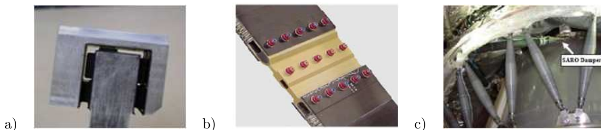
FIGURE 1.1 – Illustration des dispositifs étudiés : a) Isolateur élastomère ; b) Jonction boulonnée spatiale ; c) Amortisseur à frottement.
