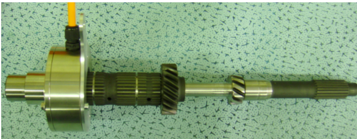
Figure II.15 : (b) Arbre primaire avec le codeur optique monté.
