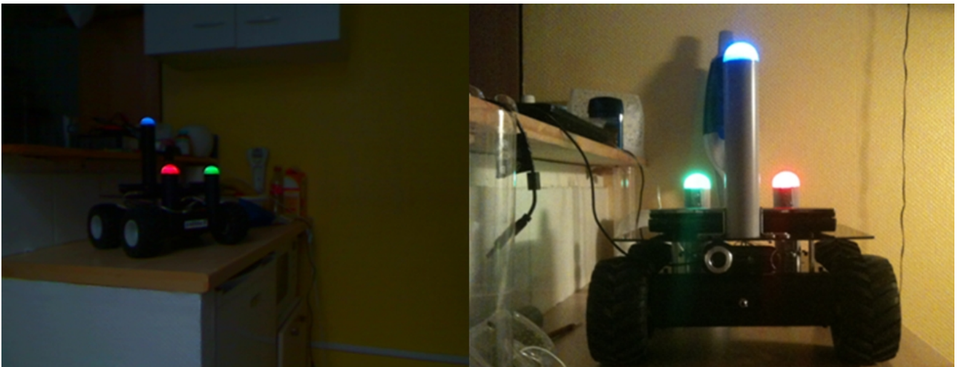
Figure 2.28 – Agencement des LEDs sur les robots, pour pouvoir déterminer la distance et l'angle sous lequel on voit un robot, ainsi que son orientation.
