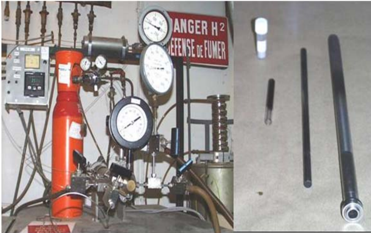
Figure II.7. Schéma de l'autoclave utilisé pour préparer les hydrures et les nitrures
