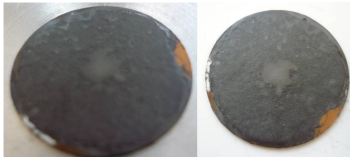
Figure 2.58 : Nanocomposite de 15 % de concentration déposé à la tournette et poncé
