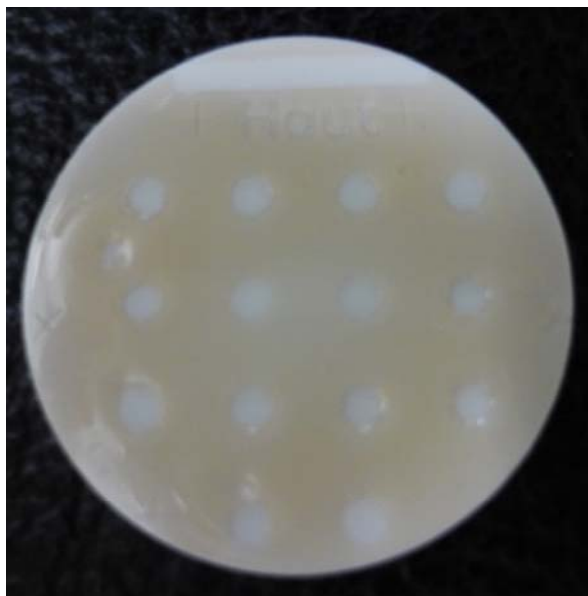
Figure 4.15: Résine SU8 non dopée insolée et révélée
