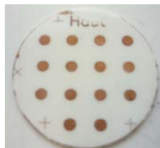
Figure 4.4: Réalisation expérimentale du plan de masse inférieur
