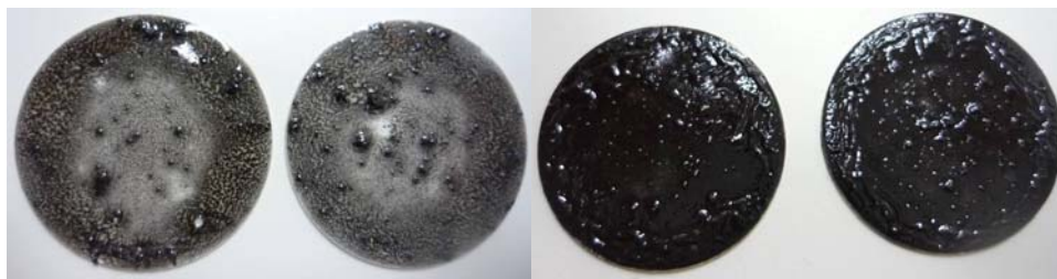
Figure 2.57 : Nanocomposites de concentrations 1 et 4 % déposés à la tournette
