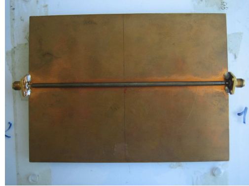
Figure 48 : Câble au-dessus d'un plan de masse
