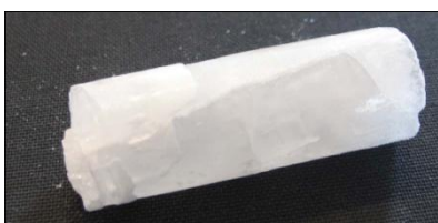
Figure 3.2 : cristal de p-TP obtenu par fusion de zone
