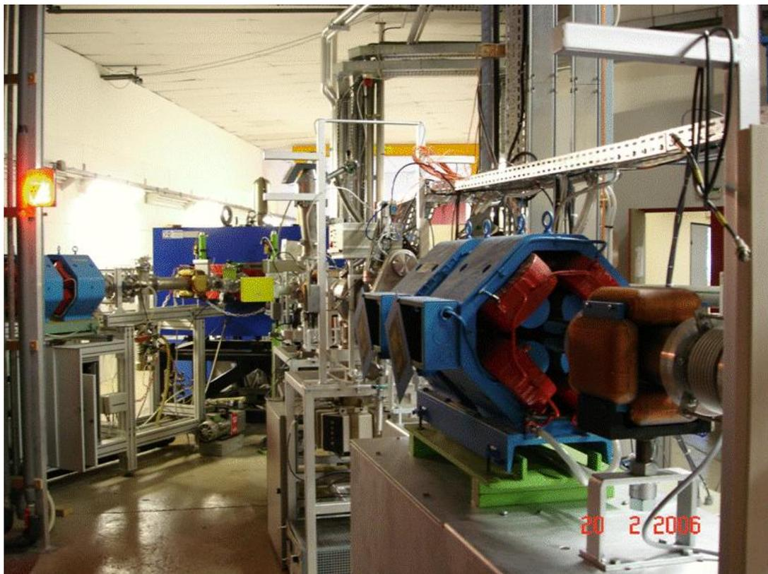
Figure 2.20 : Ligne de faisceau dédiée à la radiolyse pulsée.
