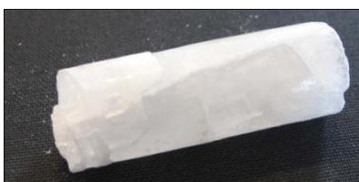
Figure 3.2 : cristal de p-TP obtenu par fusion de zone
