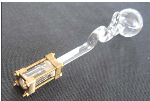
Figure 3.4 : Ampoule contenant du NE-213, spécialement créée pour les irradiations de particules chargées.
