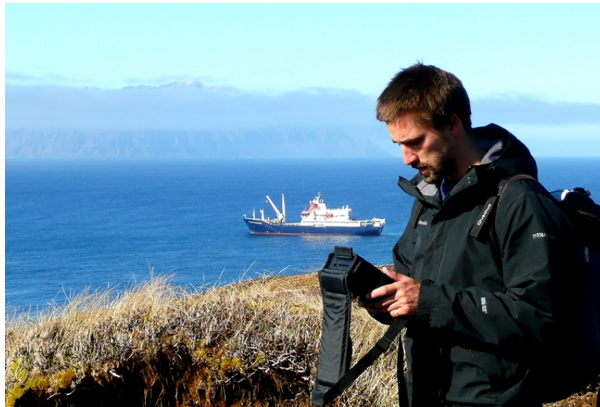
Figure 3.6: Mesure manuelle de l'épaisseur optique avec le MICROTOPS II - Cette photo a été prise à Crozet ( 52^\circ \text{ E} ; 46.4^\circ \text{ S} ) en Août 2009. Le navire de recherche Marion Dufresne se trouve à l'arrière plan (Photo : Yann Courcoux).
