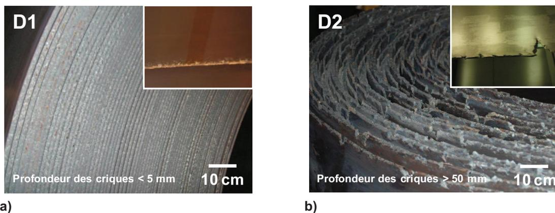
**Fig 2.** Bobines à l'issue des étapes de laminage à chaud montrant différents degrés de sensibilité aux criques de rives ; a) bobine de l'acier D1 avec des criques dont la profondeur ne dépasse pas 5 mm ; b) bobine de l'acier D2 sur laquelle les criques peuvent atteindre plusieurs centimètres.
