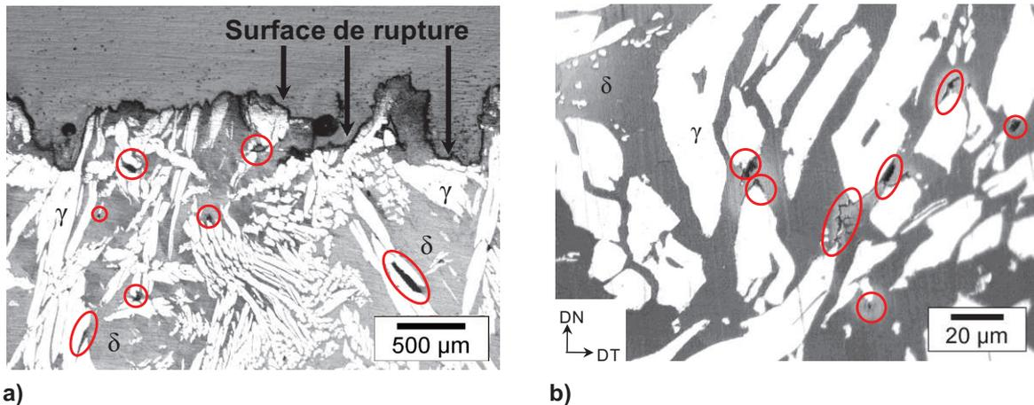
**Fig 8.** Micrographies optiques qui montrent que les cavités germent par décohésion partielle au niveau des interfaces  $\delta/\gamma$  et que les fissures ne se propagent jamais dans la phase austénitique; a) micrographie proche de la rupture d'une éprouvette pré-entaillée; b) micrographie proche des rives, c'est-à-dire des zones endommagées sur une tôle industrielle. Les sites d'endommagement sont entourés en rouge.
