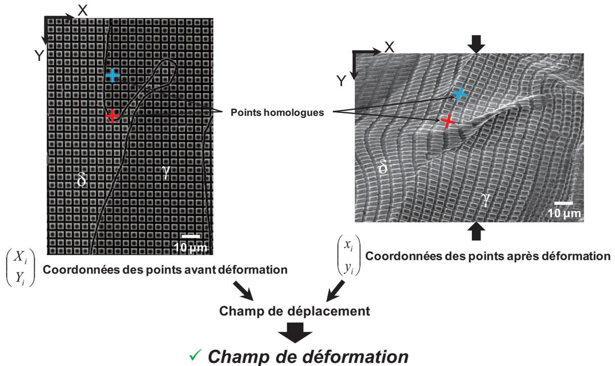
Fig 12. Principe de détermination des champs de déformation.
