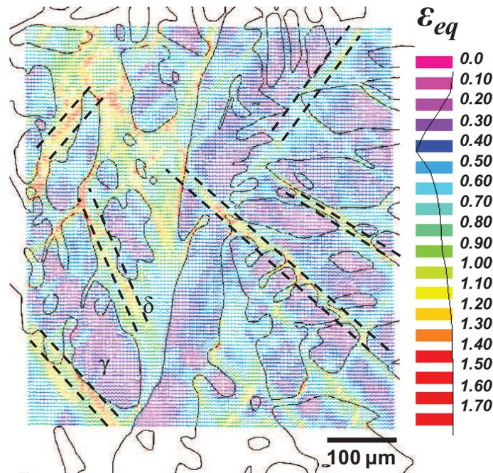
**Fig 13.** Exemple d'un champ de déformation obtenu avec l'acier D2 et dans lequel l'austénite présente une morphologie dite de Widmanstätten après une réduction de 30% à 850°C et 1s<sup>-1</sup>. Les traits en pointillés mettent en lumière le développement des bandes de cisaillement.
