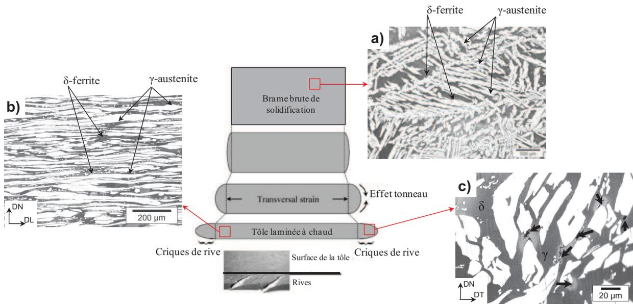
**Fig 3.** Illustration avec l'acier D2 des microstructures présentes aux différentes étapes du procédé de laminage à chaud industriel ; a) microstructure typique de la brame brute de coulée ; b) microstructure typique au centre de la tôle laminée à chaud avec un alignement des îlots d'austénite dans la direction de laminage ; c) microstructure de la tôle laminée proche des rives (zone endommagée) les cavités sont pointées par des flèches.
