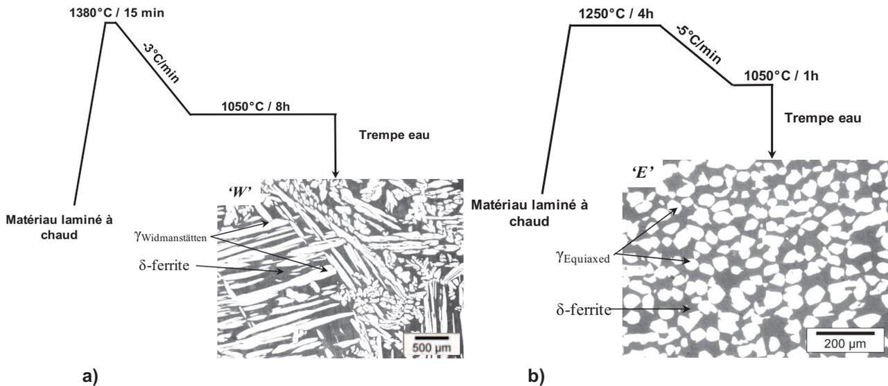
**Fig 9.** Chemins thermiques permettant de générer des microstructures modèles, exemple avec l'acier D2; a) chemin thermique pour fabriquer une morphologie d'austénite de Widmanstätten; b) chemin thermique pour générer une austénite équiaxe.
