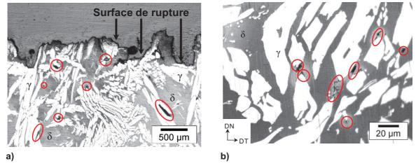
Fig 8. Micrographies optiques qui montrent que les cavités germent par décohésion partielle au niveau des interfaces  $\delta/\gamma$  et que les fissures ne se propagent jamais dans la phase austénitique; a) micrographie proche de la rupture d'une éprouvette pré-entaillée; b) micrographie proche des rives, c'est-à-dire des zones endommagées sur une tôle industrielle. Les sites d'endommagement sont entourés en rouge.
