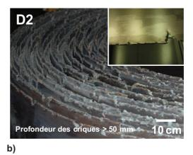
**Fig 2.** Bobines à l'issue des étapes de laminage à chaud montrant différents degrés de sensibilité aux criques de rives ; a) bobine de l'acier D1 avec des criques dont la profondeur ne dépasse pas 5 mm ; b) bobine de l'acier D2 sur laquelle les criques peuvent atteindre plusieurs centimètres.
