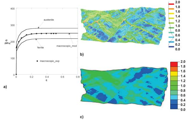
**Fig 15.** Quelques résultats obtenus sur l'acier D2 avec la stratégie développée en collaboration avec l'Université catholique de Louvain (échantillon déformé à 850°C et 1s<sup>-1</sup>); a) courbe contrainte-déformation macroscopique de l'acier D2 et rhéologies de la ferrite et de l'austénite déterminées via l'approche développée ; b) champ de déformation expérimental ; c) champ de déformation simulé.
