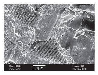
**Fig 14.** Image MEB qui montre l'état des micro-grilles après déformation à 1050°C et 10s-1, les micro-grilles s'avèrent inexploitables pour déterminer des champs de déformation.
