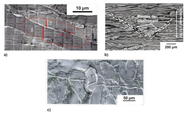
Fig 4. Illustrations de plusieurs micro-mécanismes affectant la déformation à chaud des aciers inoxydables austéno-ferritiques; a) glissement aux joints d'interphase [14]; b) développement de bandes de cisaillement [16]; c) rotation de grains austénitiques [25].
