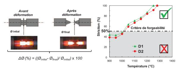
**Fig 6.** Principe de l'essai de forgeabilité standard et résultat d'un tel essai sur nos deux alliages D1 et D2.
