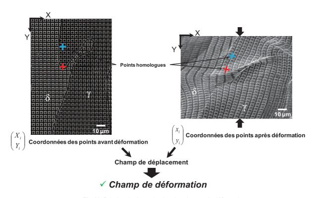
Fig 12. Principe de determination des champs de déformation.
