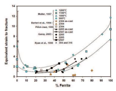
Fig 5. Influence de la fraction volumique de ferrite sur la deformation équivalente à rupture de différents aciers duplex [20].
