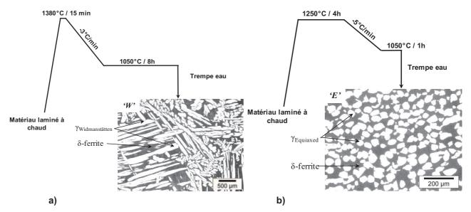
**Fig 9.** Chemins thermiques permettant de générer des microstructures modèles, exemple avec l'acier D2; a) chemin thermique pour fabriquer une morphologie d'austénite de Widmanstätten; b) chemin thermique pour générer une austénite équiaxe.
