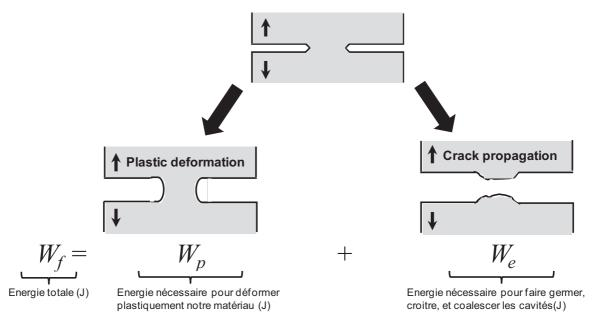
Fig 7. Principe du concept de travail essential de rupture
