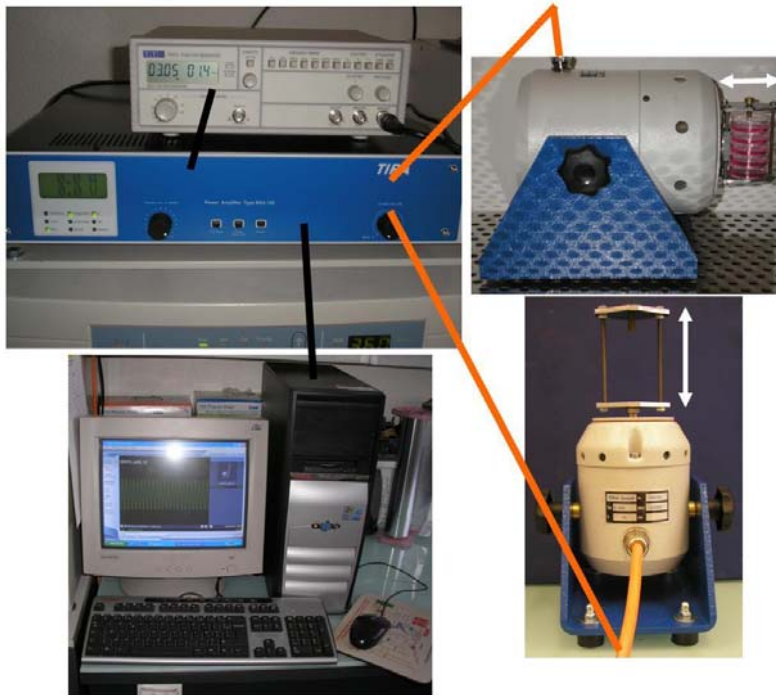
Figure 51: Schéma de fonctionnement simplifié de l'appareillage de vibration.
