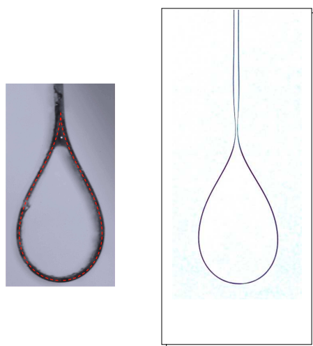
FIGURE 3.13 – Gauche : raquette formé en collant une languette élastique sur elle-même. Droite : extrémité libre d'un ruisselet.
