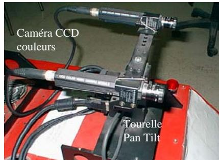
Figure III.7: Système de vision de l'ATRV2.
