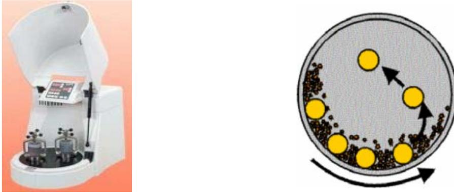
Figure 9 : Broyeur planétaire Fritsch P7 et image illustrant le mouvement des billes dans la jarre.
