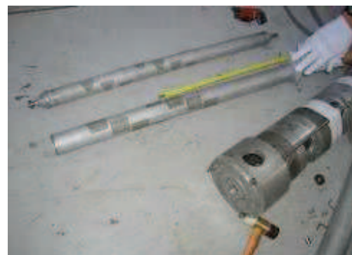
FIG. 4.4 – Barre de pilotage automatique à secteurs de cadmium du réacteur MINERVE.
