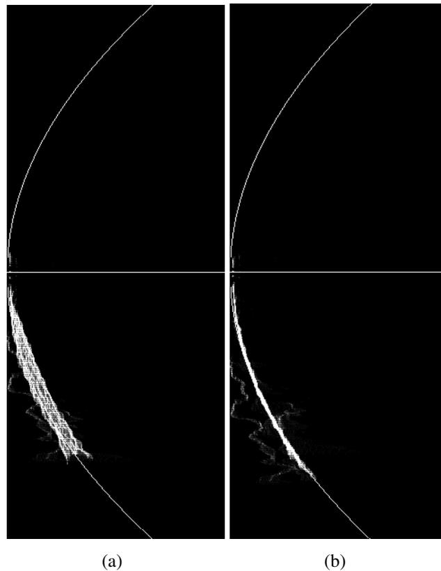
**FIGURE 4.6** – Visualisation de l'espace de vote "bâtiment" avant (a) et après optimisation (b). La déformation de la représentation C-Vélocité, induite par la position du FoE avant optimisation (a) est visiblement compensée (b).
