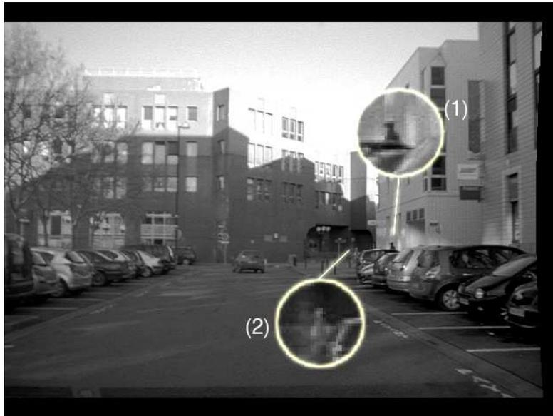
**FIGURE 3.2** – Exemples de cibles présentant potentiellement un danger, difficilement identifiable par des méthodes structurales : 1) Le piéton, à une grande distance est partiellement dissimulé par les véhicules garés ; 2) le piéton, à une très grande distance est trop loin pour être distingué des bâtiments à l'arrière plan.
