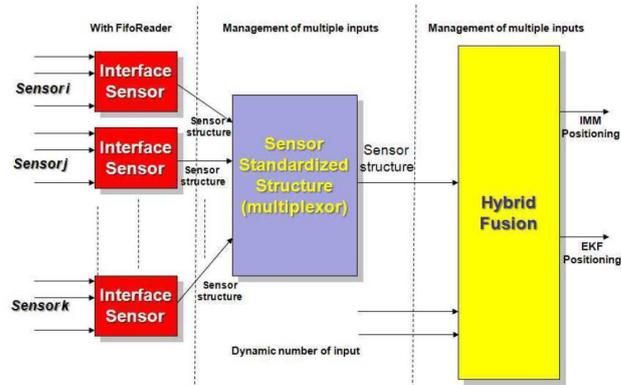
FIGURE 2.21 – Vue globale du système de fusion d'information par filtre de KALMAN étendu
