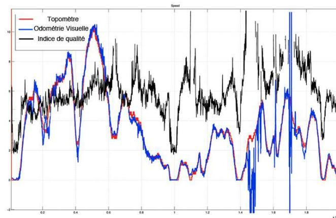
**FIGURE 2.16** – Translation Longitudinale extraite par les topomètres embarqués (rouge) et l'odométrie visuelle (bleu)
