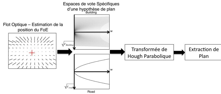
FIGURE 4.2 – Résumé du fonctionnement du processus de C-Vélocité Directe
