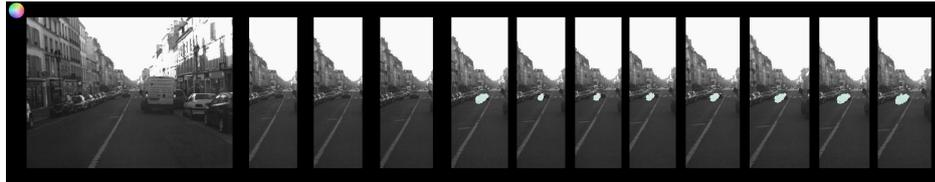
FIGURE 3.20 – Exemple de résultats obtenus. 12 frames successives sont représentées. Le véhicule est présent pendant ces douze frames, mais, jusqu'à la frame 5, sa distance au capteur est trop importante pour qu'il soit détecté, ceci illustre ce qui a été vu en 3.3.1
