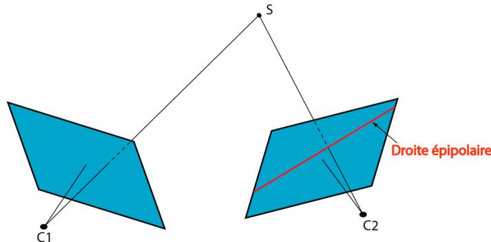
FIGURE 1.8 – Fondement de la Stéréovision - Géométrie Epipolaire
