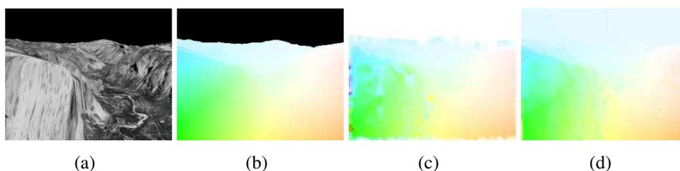
**FIGURE 1.6** – Comparaison de Différentes méthodes de flot optique, réalisée à partir de la séquence Yosemite : (a) Une des images source; (b) Image 2D du mouvement - Vérité Terrain; (c) Flot optique obtenu par une méthode locale [BC05]; (d) Flot optique obtenu par une méthode globale [WTPW09]
