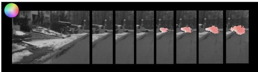
**FIGURE 3.19** – Exemples de résultats obtenus. 8 frames successives sont représentées. Le véhicule apparaît en frame 2, son mouvement est intégré en frame 2, 3 et 4. La détection commence en frame 5. L'égo-véhicule avance lentement, en tournant vers sa droite.
