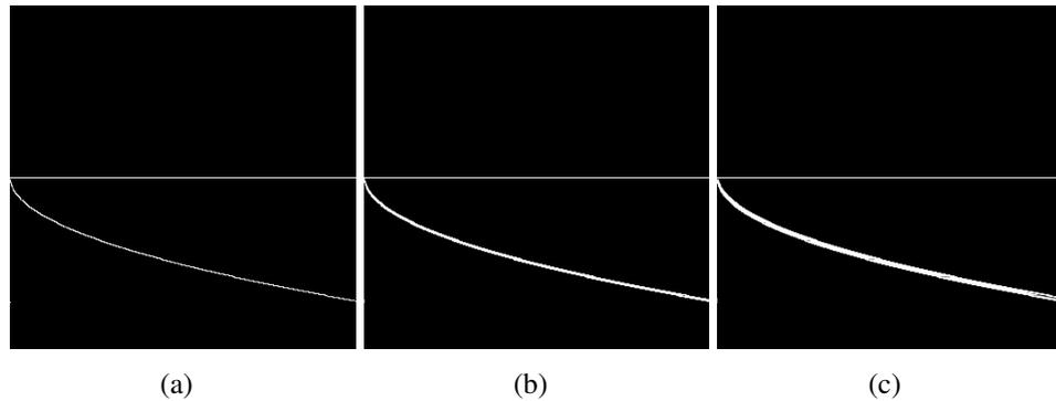
**FIGURE 4.4** – Visualisation de l’effet d’un décalage du FoE sur la C-Vélocité : (a) : Image d’un plan dans l’espace de vote adéquat avec une estimation correcte de la position du FoE ; (b) : Image d’un plan dans l’espace de vote adéquat avec une mauvaise estimation de la position du FoE (décalage de 10 pixels) ; Image d’un plan dans l’espace de vote adéquat avec une mauvaise estimation de la position du FoE (décalage 20 pixels)
