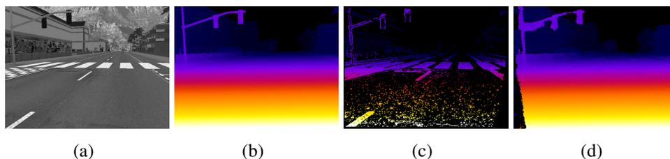
**FIGURE 2.4** – Comparaison des deux méthodes de calcul de cartes de disparité : (a) : Image Source (b) : Carte Calculée à partir du Z-Buffer de SiVIC (Vérité Terrain); (c) : Carte calculée à partir d’une méthode locale semi-dense [HLP06]; (d) Carte Calculée à partir d’une méthode Semi-Globale [EH08]
