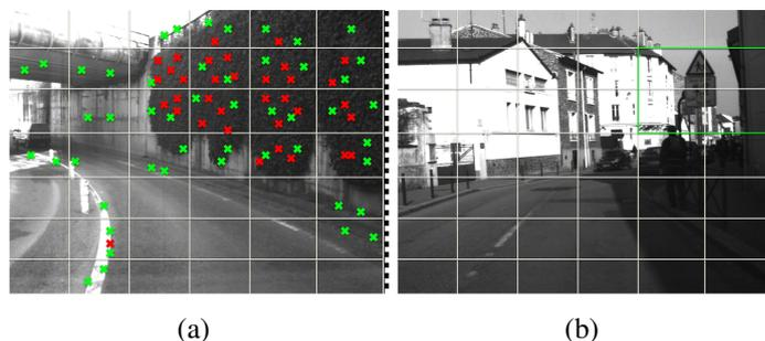
**FIGURE 2.6** – Principe et limite du bucketing; (a) Illustration du principe de "bucketing" Vert : points conservés, rouge : points éliminés; (b) Limite du "bucketing" : les quatre "buckets" en vert sont composés d'objets à plusieurs profondeurs
