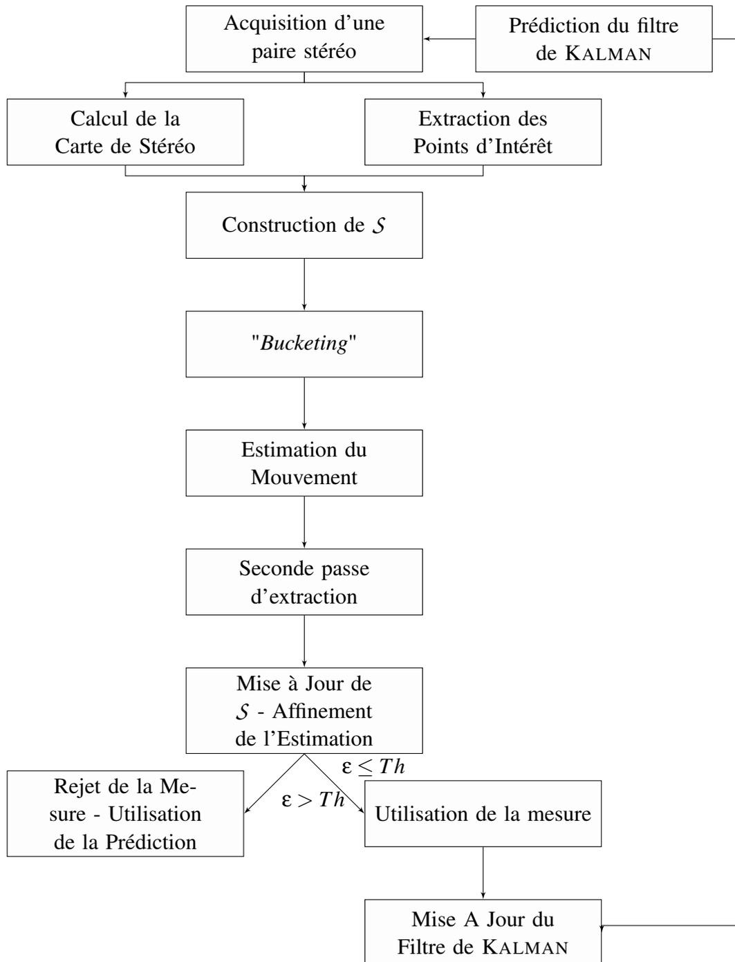
FIGURE 2.10 – Résumé du Fonctionnement de l'Odométrie Visuelle
