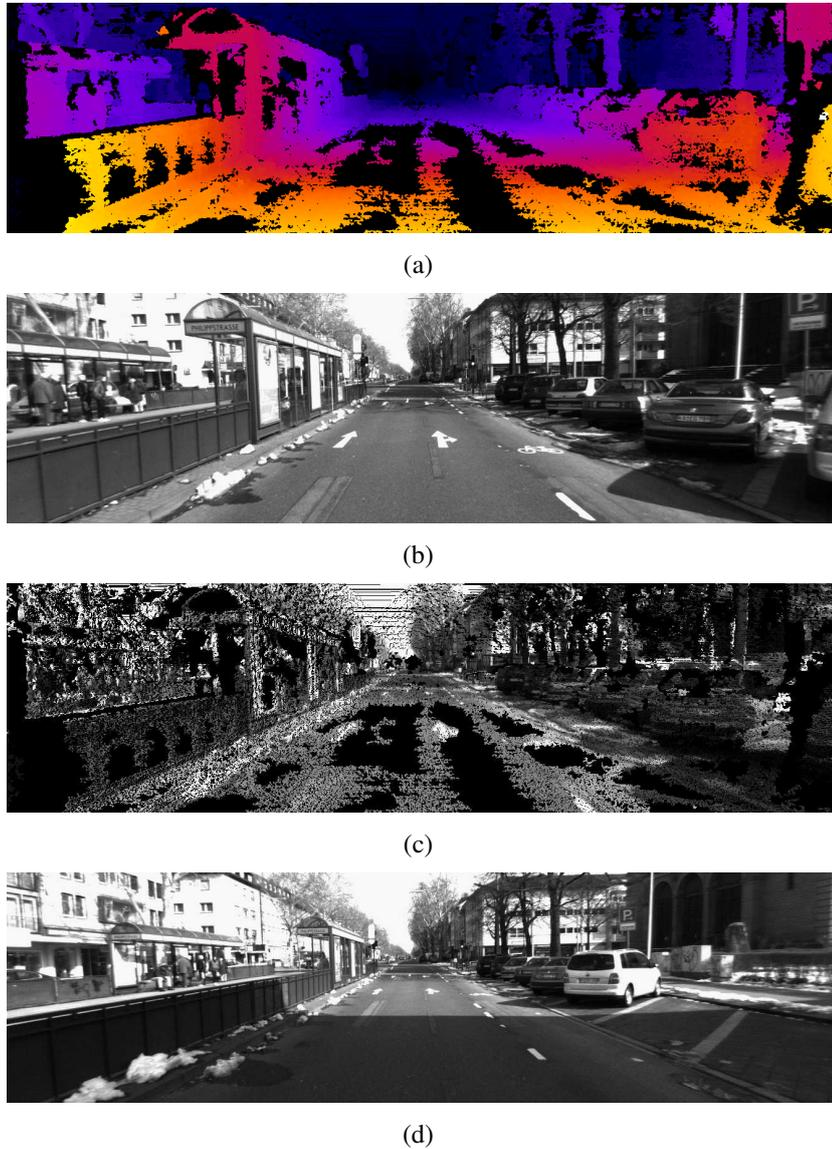
**FIGURE 3.4** – Déformation induite par le mouvement : (a) : Carte de Disparité à  $t_1$  ; (b) : Image  $I_1$  ; (c) : Image  $I_0$  déformée ; (d) : Image  $I_0$ . Pour des raisons d'illustration, le mouvement a été amplifié ( $t_1 - t_0 = 2s$ )
