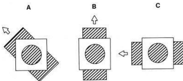
**FIGURE 1.5** – Problème d’ouverture : dans les scénarios A, B et C, le mouvement perçu à travers l’ouverture sera le même, même si les mouvements physiques à l’origine de l’observation sont différents.
