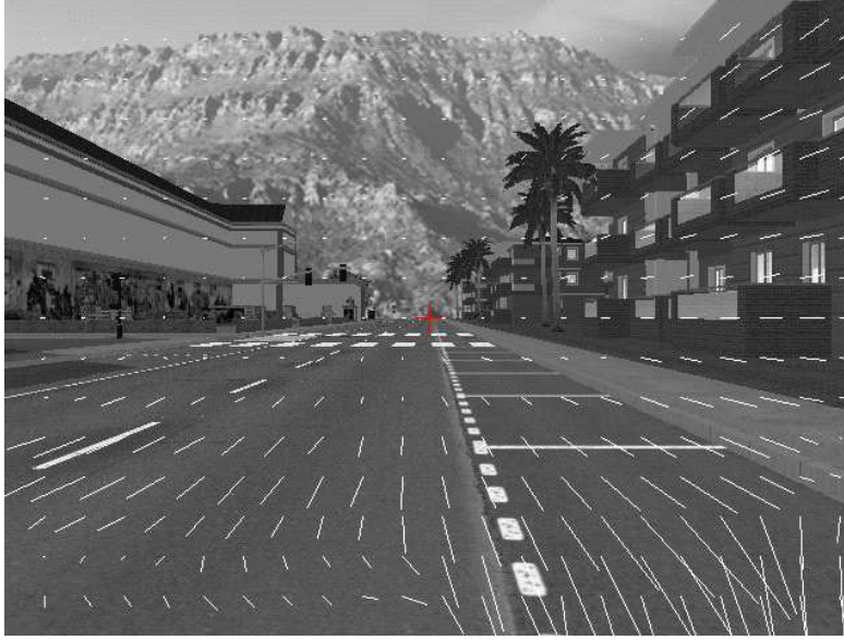
FIGURE 4.1 – Image issue d’une séquence simulée, flot optique calculé par la méthode FOLKI [BC05] et Foyer d’Expansion extrait par C-Vélocité Inverse
