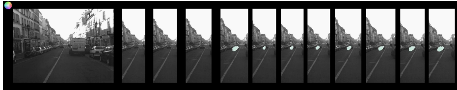
FIGURE 3.20 – Exemple de résultats obtenus. 12 frames successives sont représentées. Le véhicule est présent pendant ces douze frames, mais, jusqu'à la frame 5, sa distance au capteur est trop importante pour qu'il soit détecté, ceci illustre ce qui a été vu en 3.3.1
