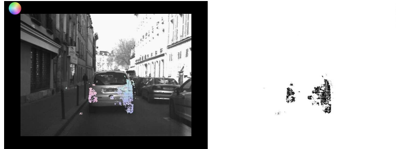
FIGURE 3.22 – Illustration d’une détection reposant sur le mouvement axiale. Le véhicule détecté présente un mouvement purement longitudinal. Les composantes latérales de son mouvement résiduel sont faibles, contrairement à la composante axiale de son mouvement résiduel, qui permet d’assurer une bonne détection. Il est toutefois notable que cette détection est limitée par la densité de la carte de disparité, qui peut présenter des "trous".
