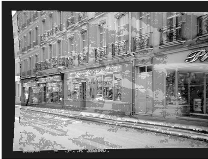
FIGURE 3.23 – Variations d’intensité dues à des surfaces non-lambertienenes. Les variations ont été artificiellement augmentées à des fins d’illustration.
