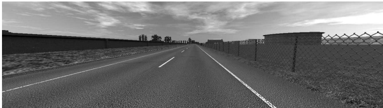
FIGURE 2.14 – Extrait d'une séquence générée par SiVIC, les seules zones suffisamment texturées de l'image pour permettre une extraction efficace de points d'intérêts sont également les zones présentant des motifs très répétitifs (route, grillage, ...), ce qui empêche une estimation efficace du mouvement.
