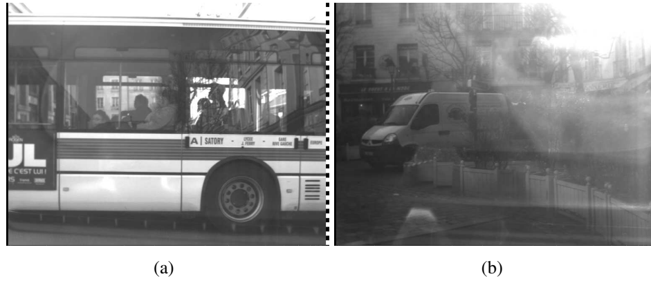
FIGURE 2.17 – Illustration des défaillances de l’odométrie visuelle : (a) : le champ est intégralement occupé par un plan fronto-parallèle ; (b) la qualité de l’imagerie est dégradée par des conditions météorologiques dégradées
