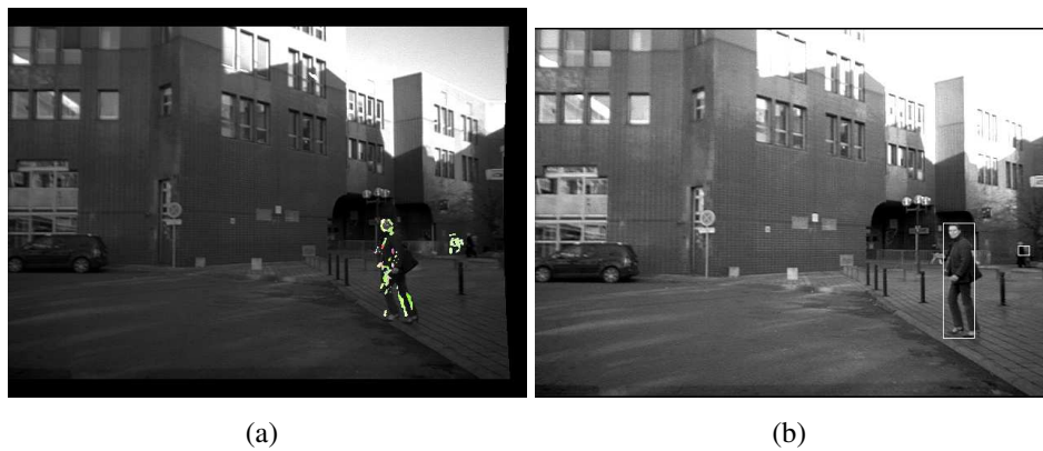
FIGURE 3.10 – Illustration de la méthode de Clustering : (a) Image de détection initiale ; (b) : clusters extraits
