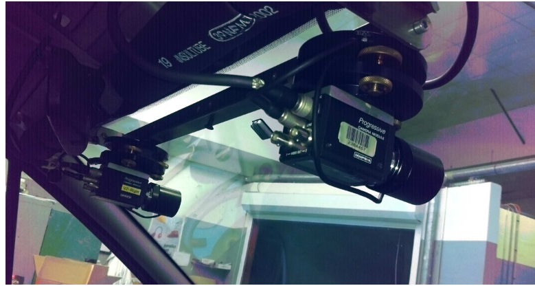
FIGURE 1.7 – Paire stéréo installée dans le prototype CARLLA du LIVIC
