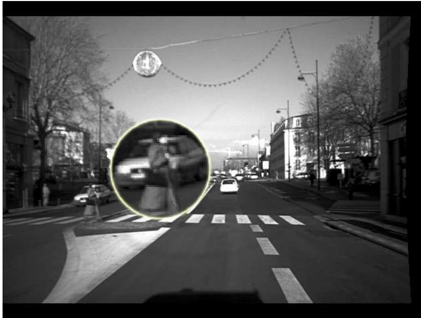
FIGURE 3.14 – Pouvoir de Résolution : Les deux cibles mises en évidence sont coïncidentes, il est toutefois nécessaire de pouvoir les différencier car l'une peut présenter un danger, alors que l'autre n'est pas sur une trajectoire de collision avec l'égo-véhicule.
