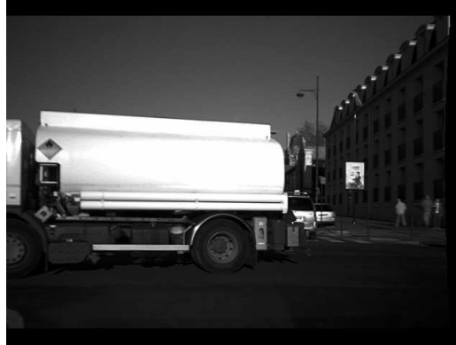
FIGURE 2.9 – Le camion blanc au premier plan occupe la majorité du champ. En cas d'extraction du mouvement, le mouvement dominant apparent sera le mouvement relatif entre le camion et l'égo-véhicule.
