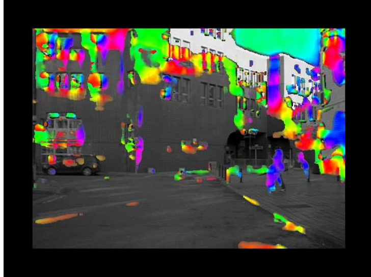
FIGURE 3.8 – Exemple de faux positifs, dûs à un brusque changement d’illumination, correctibles par une intégration temporelle des résultats de détection.
