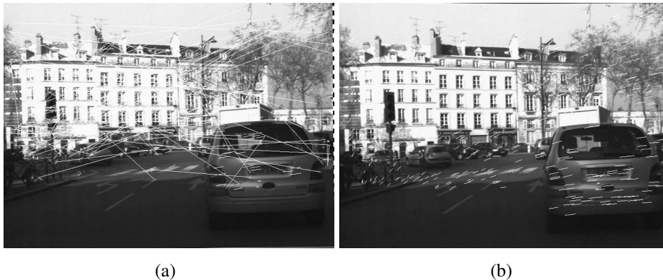
FIGURE 2.8 – Comparaison des stratégies d’extraction de points d’intérêts : (a) : extraction simple ; (b) extraction après une première estimation frustrée du mouvement, la majorité des faux appariements ont disparu.
