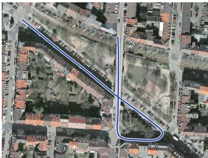
FIGURE 2.19 – Trajectoire Recalculée à partir du mouvement extrait - recalée sur une vue aérienne - Karlsruhe
