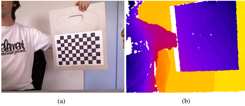
FIGURE D.4 – Images obtenues via le capteur Kinect®: (a) image couleur ; (b) : carte de profondeur
