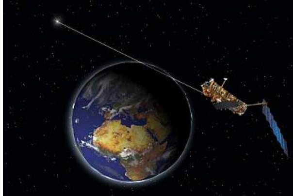
Fig. 2.4 – Vue d’artiste d’une observation de l’atmosphère terrestre par occultation stellaire par l’instrument GOMOS, à bord du satellite européen ENVISAT. (ESA)
