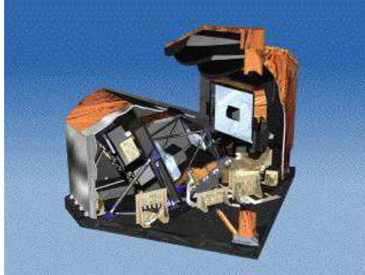
Fig. 2.6 – Dessin en trois dimensions de la structure interne de l'instrument GOMOS / ENVISAT. (ESA)
