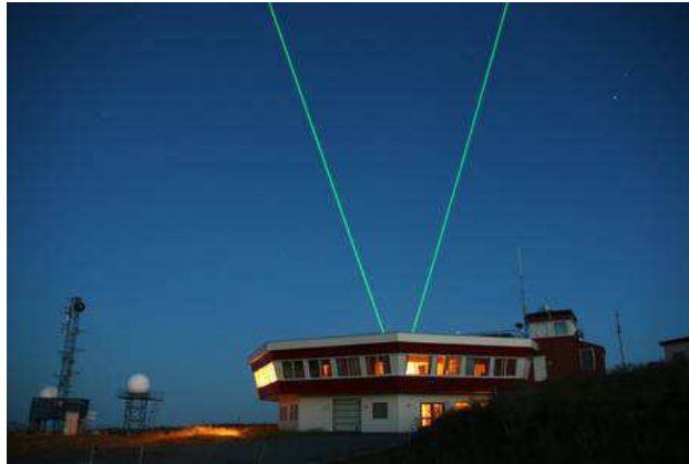
Fig. 1.14 – Le lidar Rayleigh/Mie/Raman de l’observatoire d’ALOMAR (Arctic Lidar Observatory for Middle Atmosphere Research), installé sur l’île d’Andøya (Norvège, 69°N), joue un rôle important dans l’observation des nuages noctulescents. (Leibniz-IAP)
