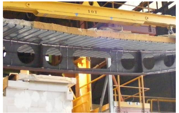
b) Partie centrale après la ruine
