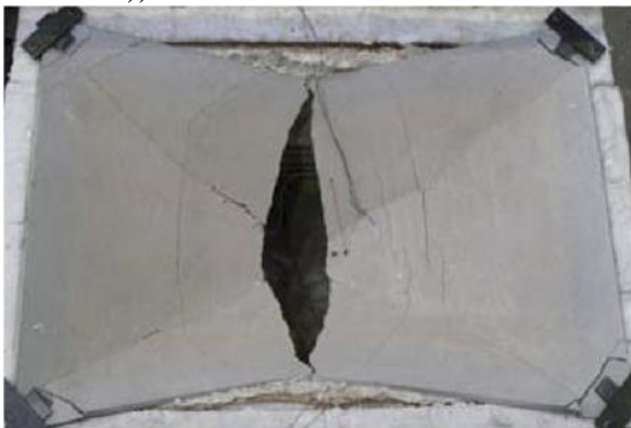
a) Fissuration centrale (essai à chaud)
