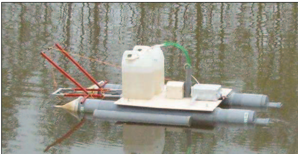
Figure 2.4 : Radeau d'échantillonnage télécommandé
