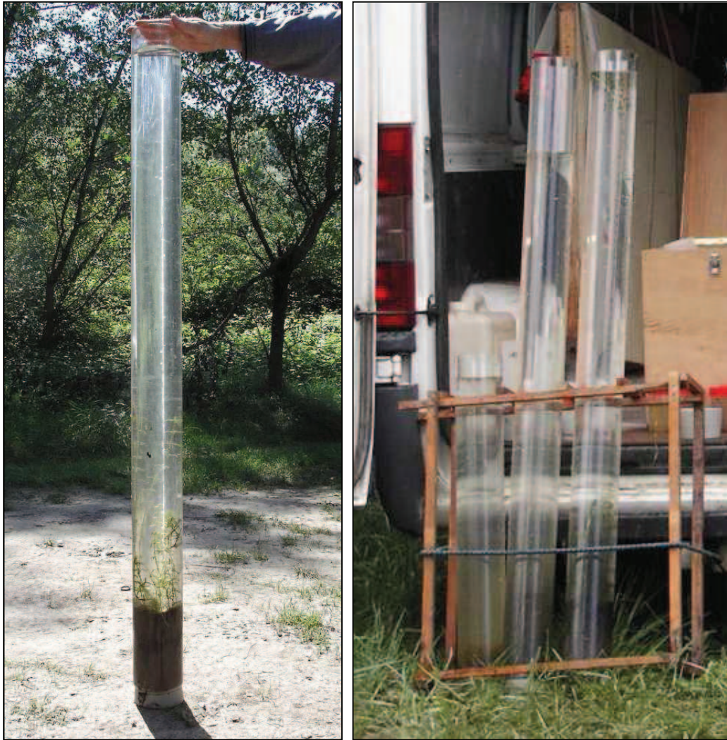
Figure 2.3 : Colonnes en plexiglas utilisées pour les prélèvements de zooplancton destinés aux comptages
