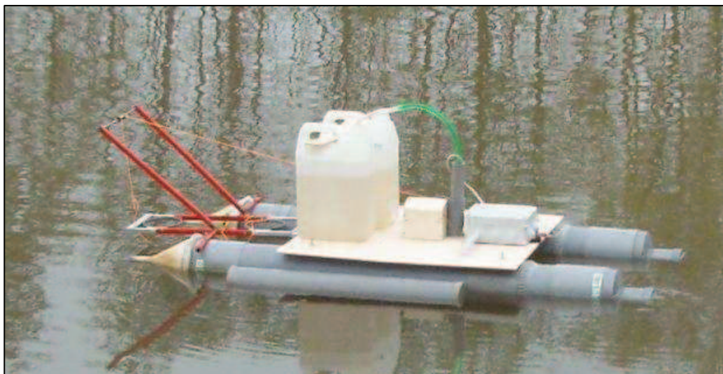
Figure 2.4 : Radeau d'échantillonnage télécommandé
