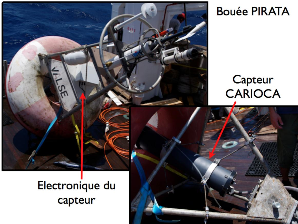
**Figure II.2** – Bouée PIRATA avec capteur CARIOCA (en bas à droite) et l'électronique du capteur sur le portique de la bouée (en haut à gauche). En haut du portique, se trouvent les instruments météorologiques. (Photos prises pendant la campagne PIRATA FR 20 G.Parard, J.Grelet).
