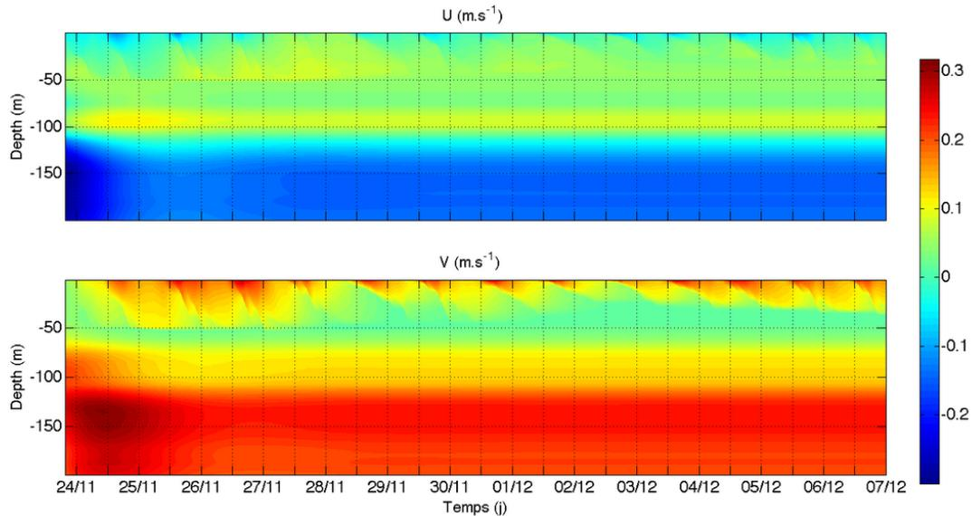
**Figure IV.14** – Evolution du courant simulé entre 0-200 m au cours de la période "physique",  $U$  correspond à la composante zonale et  $V$  la composante méridienne.  $U > 0$  vers l'est et  $V > 0$  vers le nord.
