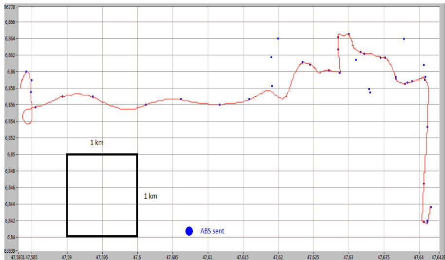
Figure III.12 – Les alertes d'ABS envoyées par les véhicules
