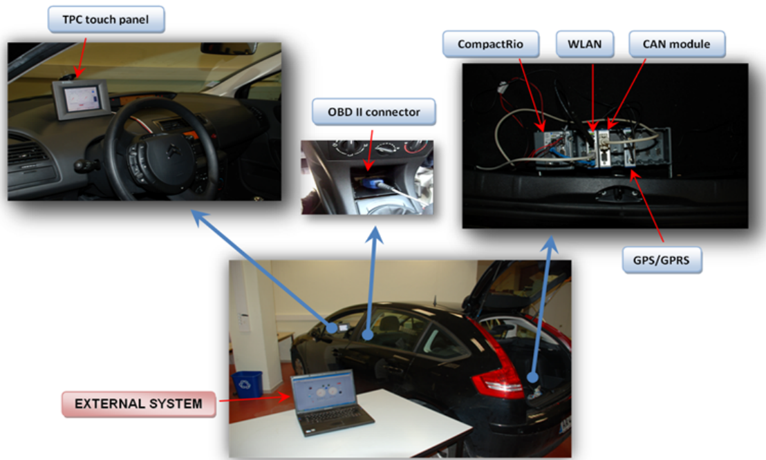
Figure II.21 – l'implémentation du système PCAN dans la Citroën C4
