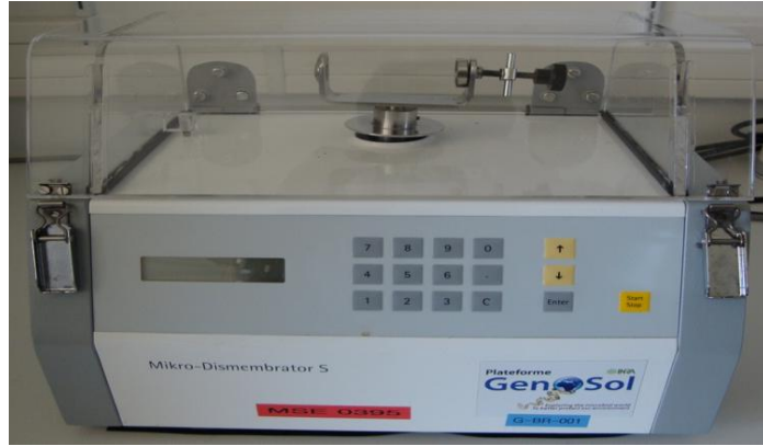
Photo II-4. Mini-bead beater disrupter (Mikro-Dismembrator S, Sororius)
