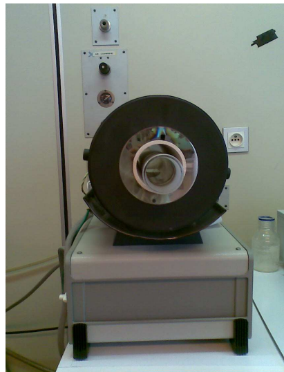
Figure IV-4: Photographie du four tubulaire.
