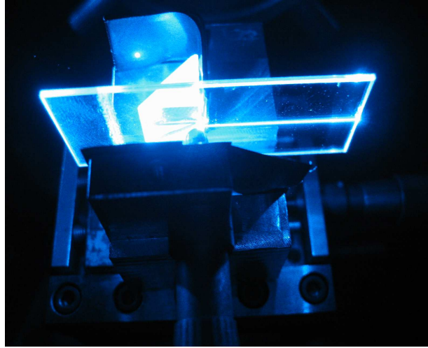
Figure I-20: Guide d'onde pour une mesure en spectroscopie de diffusion Raman en configuration guidée.
