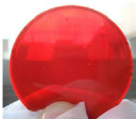
FIG. 2.14 – Exemple de scintillateur dopé en Plomb à 10% en masse, dont nous avons décalé la longueur d'émission vers le rouge par du Nilred.
