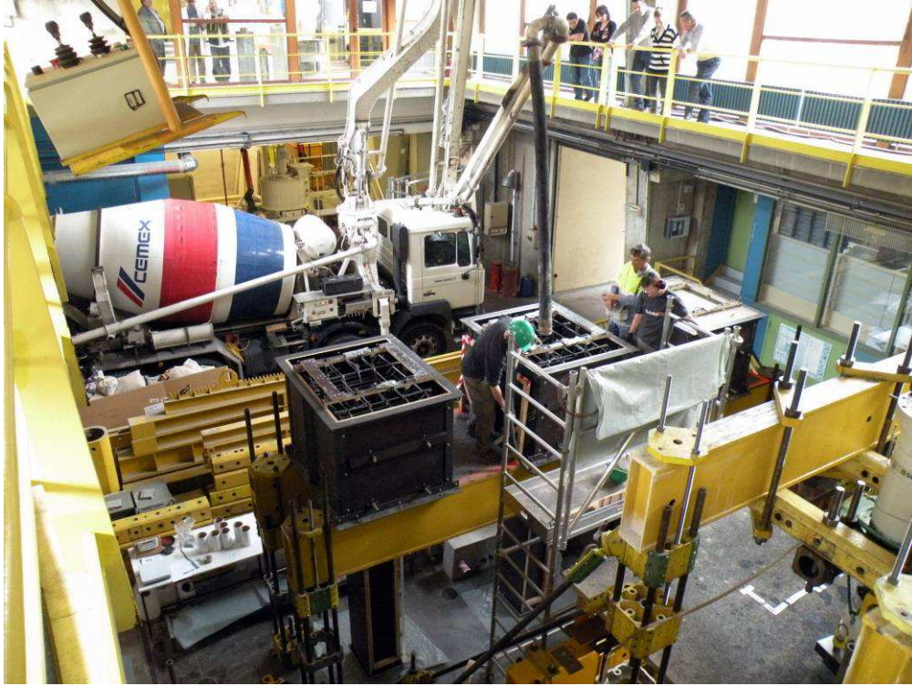
Figure 3-9 : Site de coulage de 3 corps d'épreuve.
