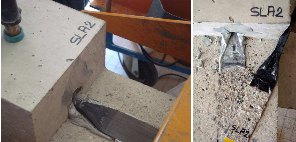
Figure A2- 9 : Glissements successifs de l'ancrage pour le bloc SLA2, puis finalement extraction du système de renforcement.
