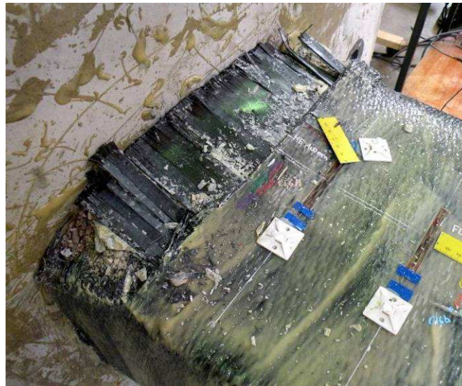
Figure 3-35 : État des lamelles à la fin de l'essai sur PCL1.
