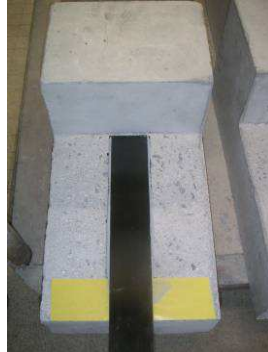
Figure A1- 1: Corps d'épreuve avec lamelles simples collées.
