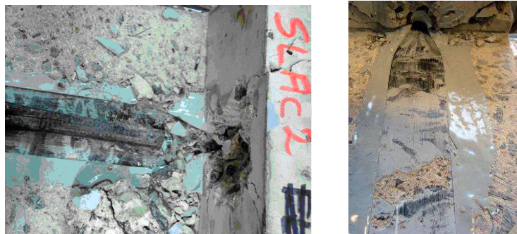
Figure A3- 7 : État de surface après extraction de la lamelle - essai SLAc2.
