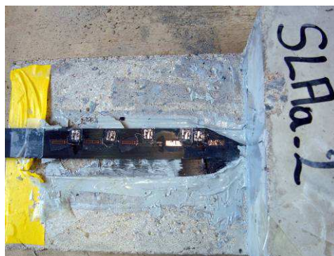
Figure 2-42 : Rupture du corps d'éprouve SLAa2.
