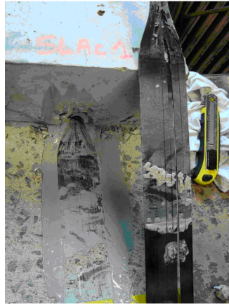
Figure A3- 5 : État de surface après rupture - essai SLAc1.
