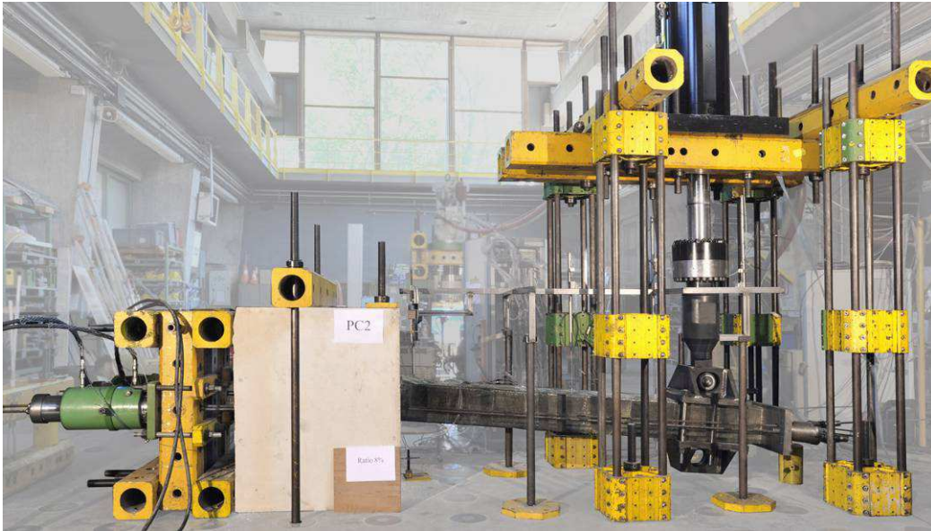
Figure 3-61 : Illustration du phénomène de rotation de corps rigide sur les poteaux renforcés.
