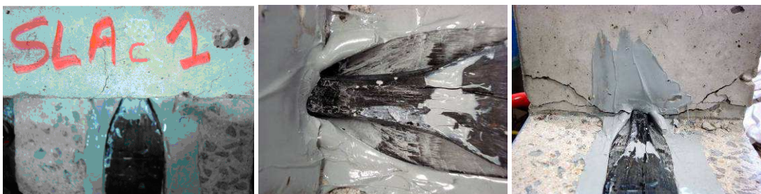
Figure A3- 4 : Sortie progressive de la partie ancrée de la lamelle et éclatement/fissuration du bloc béton au niveau de l'ancrage _ essai SLAc1.
