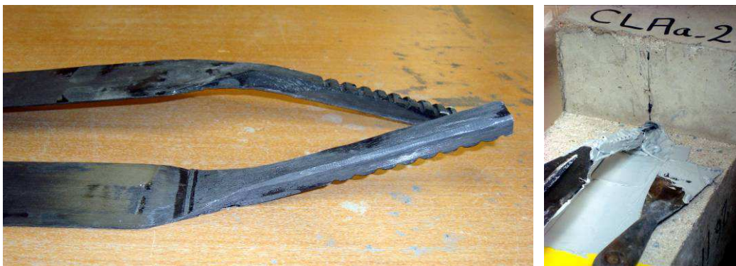
Figure 2-27 : Système d'ancrage avec angle.
