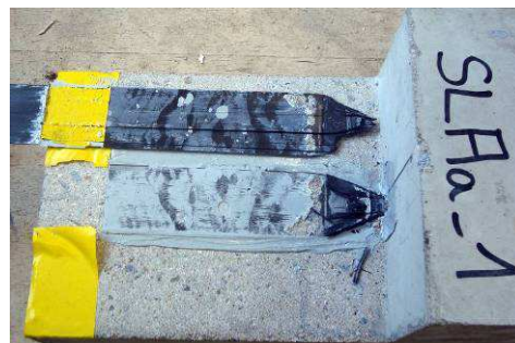
Figure 2-37 : Rupture du spécimen SLAa1.
