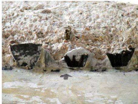
Figure 3-55 : Rupture des lamelles ancrées au niveau de la zone de transmission des efforts entre la partie courante et la lamelle ancrée.
