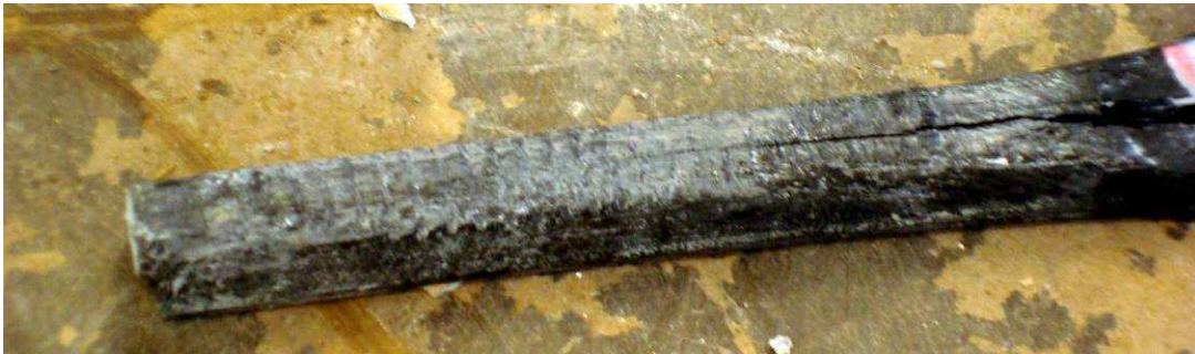
Figure A3- 22 : photo illustrant la rupture en cisaillement des crans de la lamelle.
