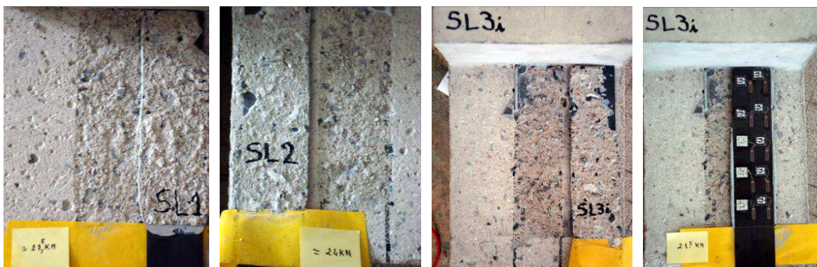
Figure A1- 4 : Rupture des corps d'épreuve lors des essais statiques sur lamelles simples.
