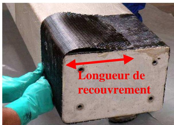
Figure 3-15 : Zone de recouvrement des bandes de PRF à base de tissu.
