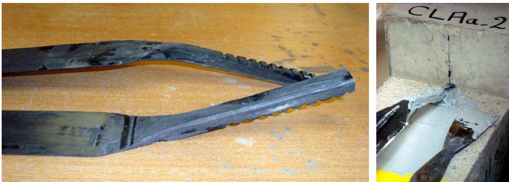
Figure 2-27 : Système d'ancrage avec angle.
