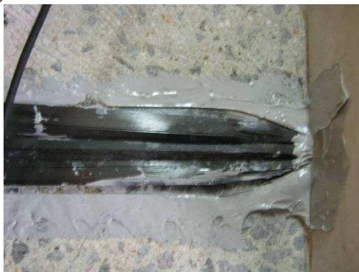
Figure A3- 19 : Fibres endommagées de la lamelle ancrée lors des essais cycliques CLAc\_1 (photo prise lors des derniers cycles à 33,9 kN).
