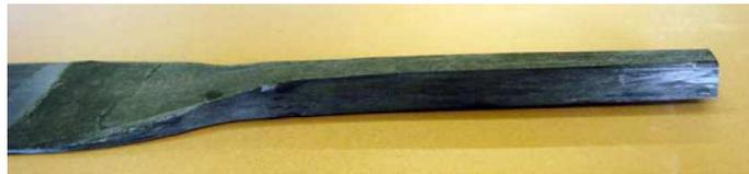
**Figure 2-22 : Description de la lamelle et de son ancrage – cas où l’ancrage est dans l’alignement de la partie courante de la lamelle.**
