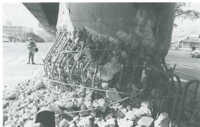
Figure 1-5 : Ruine de pile par rupture de soudure des aciers longitudinaux (Kobe, 1995), d'après [Priestley et al., 1996].
