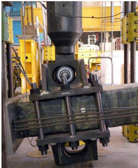
Figure 3-22 : Système de « casque » rotulé assurant la transmission des efforts latéraux.
