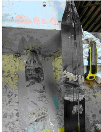
Figure A3- 5 : État de surface après rupture - essai SLAc1.
