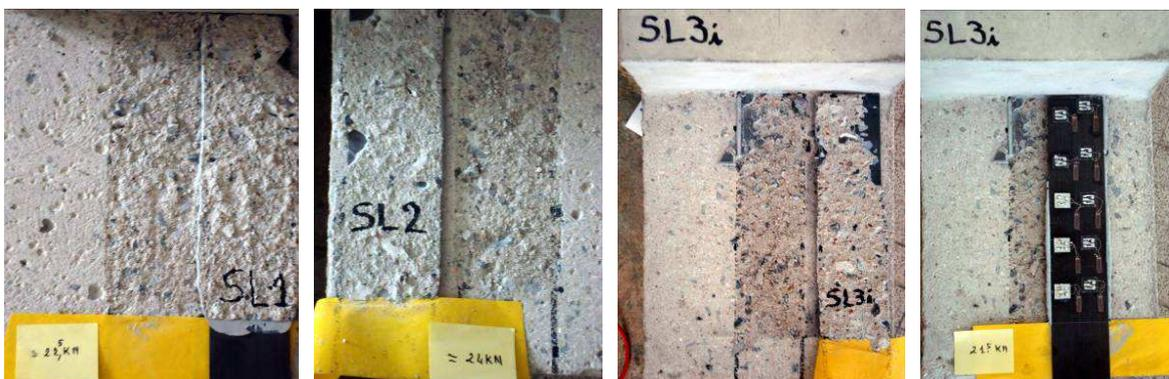
Figure A1- 4 : Rupture des corps d'épreuve lors des essais statiques sur lamelles simples.
