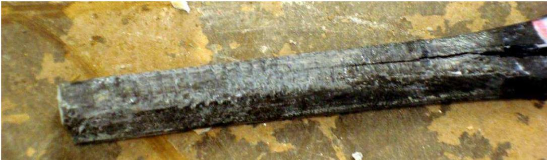
**Figure A3- 22 : photo illustrant la rupture en cisaillement des crans de la lamelle.**
