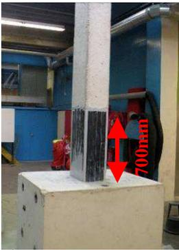
Lamelles ancrées avec une partie courante collée de hauteur 700 mm (même configuration d'ancrage que pour PCLA : pas d'ancrages sur les faces latérales, et 3 ancrages sur les faces supérieure et inférieure – voir Figure 3-13)
