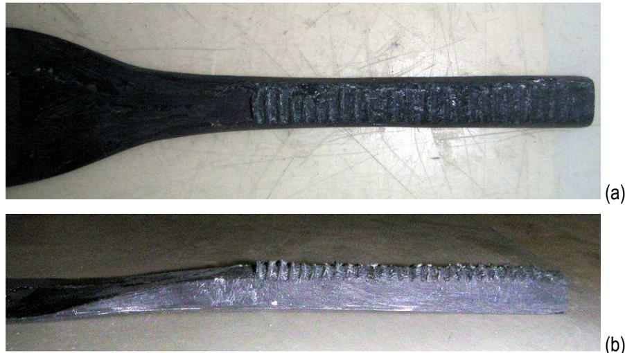
Figure A3- 1 : nouvelles lamelles à ancrage spécifique cranté ((a) : vue de dessus et (b) : vue de profil).
