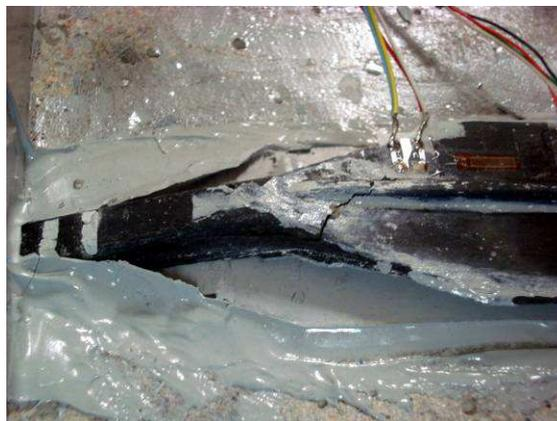
Figure 2-53 : Cylindre d'extrémité arraché de son trou de scellement (SLAa3).
