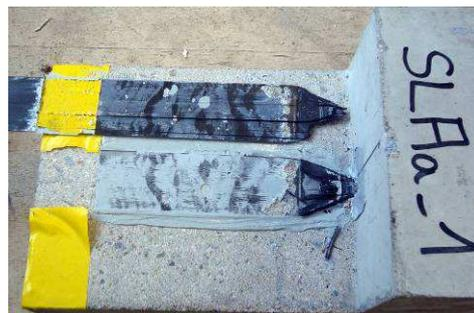
Figure 2-37 : Rupture du spécimen SLAa1.
