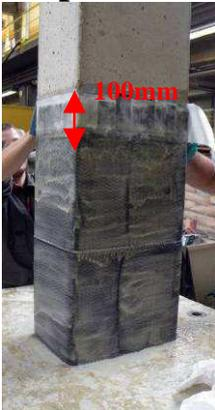
1 couche de confinement par tissu de fibres de verre, sur une hauteur de 100 mm
