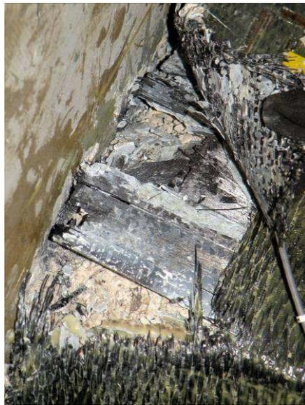
**Figure 3-37 : Fin de l'essai sur PCLA2, les ancrages composites sont écrasés.**
