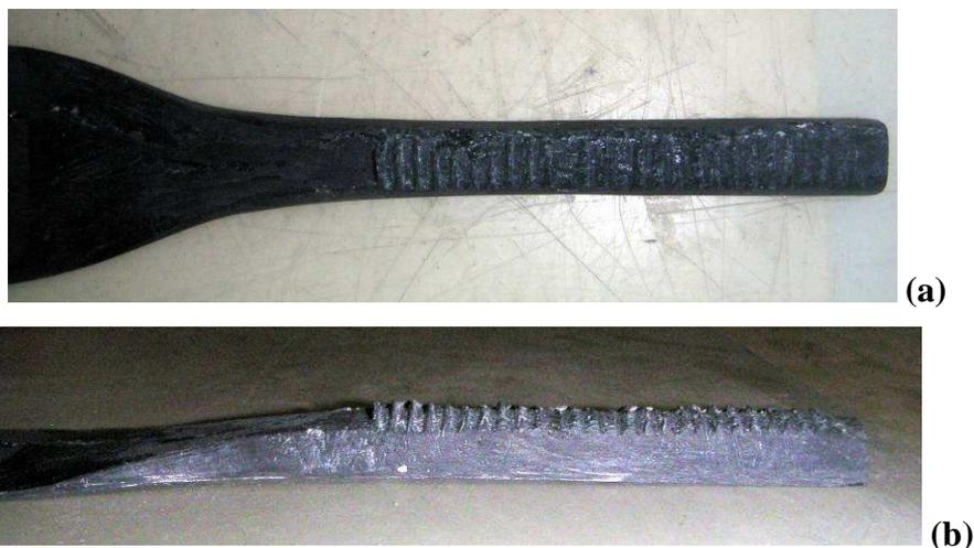
Figure 2-25 : Cylindre cranté en extrémité de la lamelle – version pour laquelle le cylindre d'ancrage est dans l'alignement de la partie courante de la lamelle.
