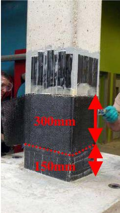
1 couche de confinement par TFC sur une hauteur de 450 mm (une bande de largeur 150 mm en pied, puis une bande de largeur 300 mm)
