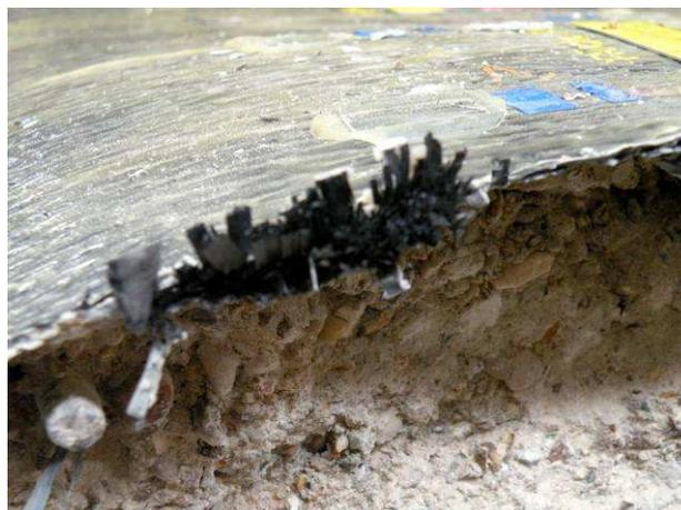
Figure 3-36 : Fibres libres suite à l'écrasement des ancrages – autopsie de PCLA1.
