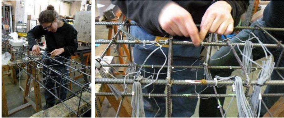
Figure 3-25 : Mise en place des jauges de déformation sur aciers.
