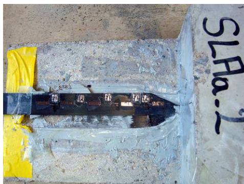
**Figure 2-42 : Rupture du corps d'éprouve SLAa2.**
