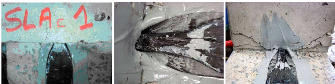
Figure A3- 4 : Sortie progressive de la partie ancrée de la lamelle et éclatement/fissuration du bloc béton au niveau de l'ancrage \_ essai SLAc1.
