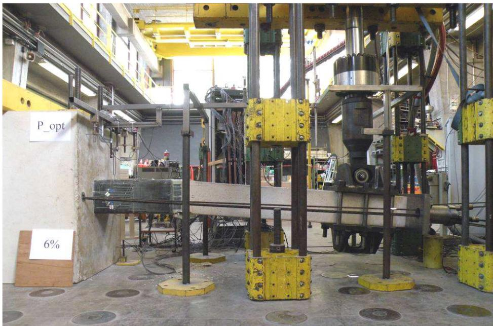
Figure 3-58 : Déformée de PCLA<sub>partiel</sub> lors de la sollicitation.
