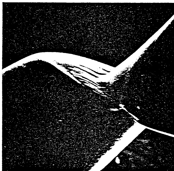
Fig. 1.24 - Zone de cisaillement due à l'amollissement thermique dans un cristal de Niobium, durant un test en tension à 4,2 K. Le diamètre de l'échantillon est de 2 mm (d'après Kubin et Jouffrey, 1971).
