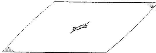
Fig. 3.4 - Densités de déformation dans le cas de la simulation correspondante à la figure 3.3. La zone hachurée est déformée à plus de 1,1 et la zone pointillée à moins de 0,9.
