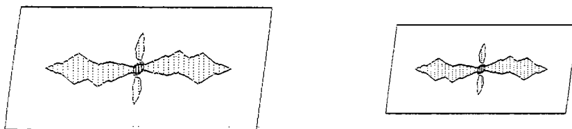
Fig. 4.11 - Perturbations créées par deux hétérogénéités lors de deux déformations identiques. Les perturbations sont proportionnelles aux hétérogénéités. Les hétérogénéités sont en hachuré et les perturbations en pointillé.
