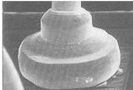
FIGURE 1.19 – Connexion de type ball bonding (photo tirée de la référence [55]).
