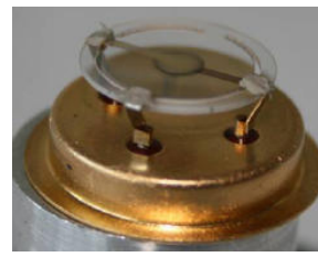
FIGURE 4.8 – Résonateur à quartz : architecture type BVA 4 ponts.
