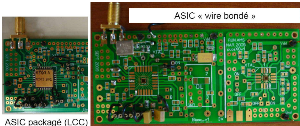
FIGURE 2.59 – Circuit de test pour valider les performances des ASIC "PuceXOv1" et "Eliosc_v1".
