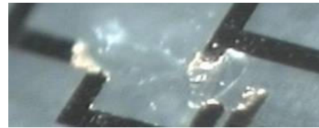
FIGURE 4.30 – Arrachement des pistes métalliques après cisaillement de la puce.
