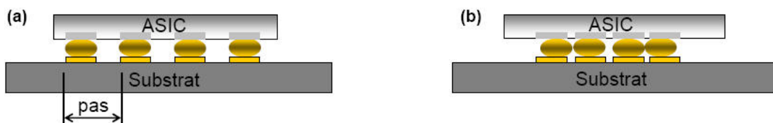
FIGURE 2.13 – Le pas choisi pour le assurer le flip chip de nos ASIC est fonction du diamètre des bumps (type de capillaire et diamètre du fil) et des tolérances de positionnement lors de la dépose : cas favorable (a) et défavorable (b).
