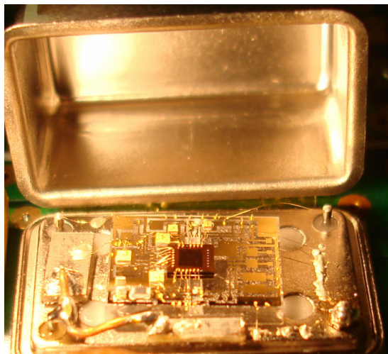
FIGURE 4.37 – Assemblage de notre ASIC dans un boîtier DIL ( 20 \times 12,5 \text{ mm}^2 ).
