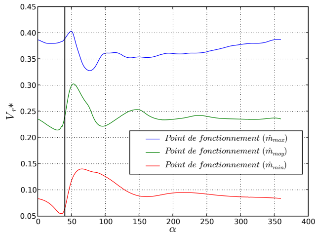
FIG. 5.43: Distribution de vitesse radiale à l'entrée de la volute. — : ( \dot{m}_{max} ), — : ( \dot{m}_{moy} ), — : ( \dot{m}_{min} ).
