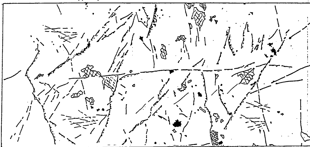
Figure V-2: Microfracturation synchronisée de la déformation fragile. A noter l'orientation privilégiée N-S et NE-SW
