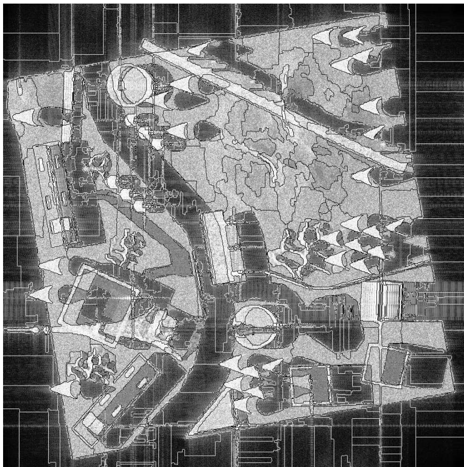
FIGURE 3.22 – Segmentation de la scène synthétique. La couleur des frontières est calculée par contraste avec la région voisine (Blanc sur Noir / Noir sur Blanc).
