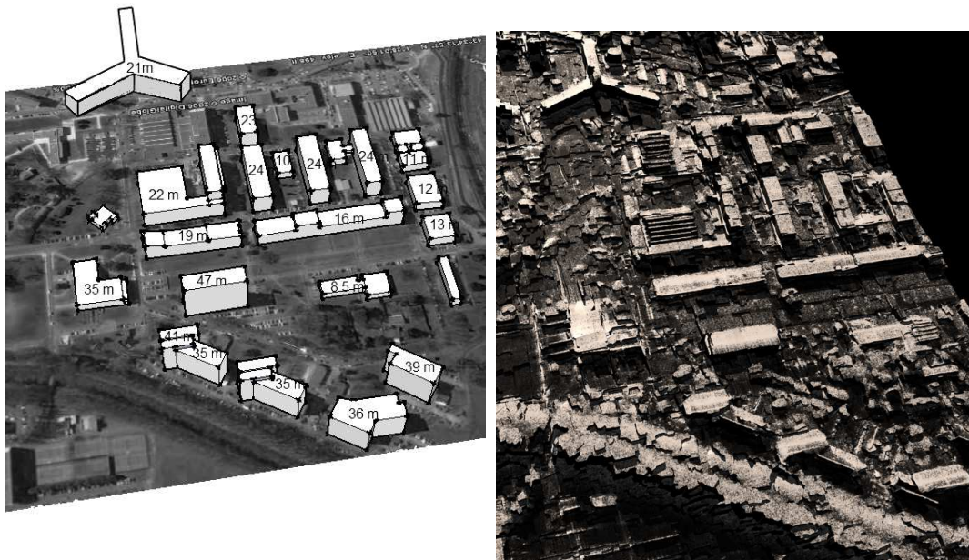
FIGURE 3.6 – Vérité terrain publique obtenue grâce à Google Earth, et représentée sur Google SketchUp, à comparer à une carte en 3D obtenue à l'aide du radar.
