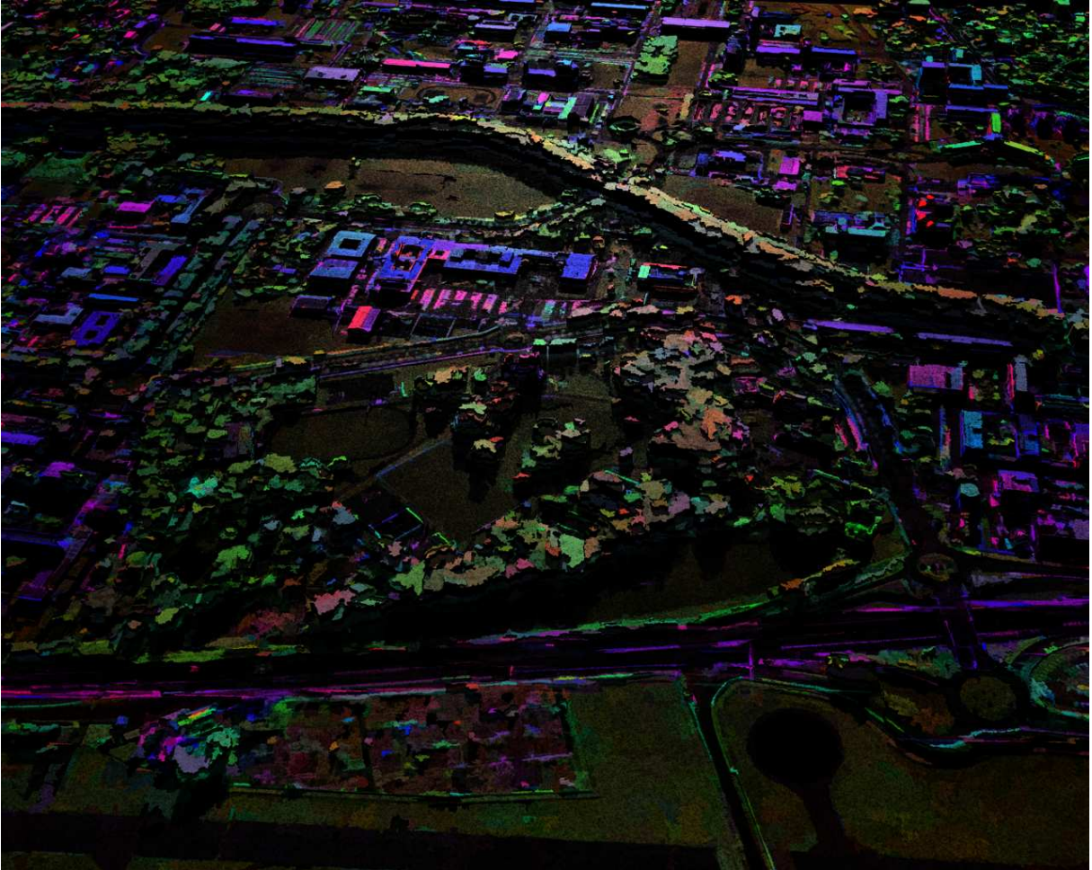
FIGURE 3.9 – Illustration de la restitution 3D avec une représentation de Pauli comme texture
