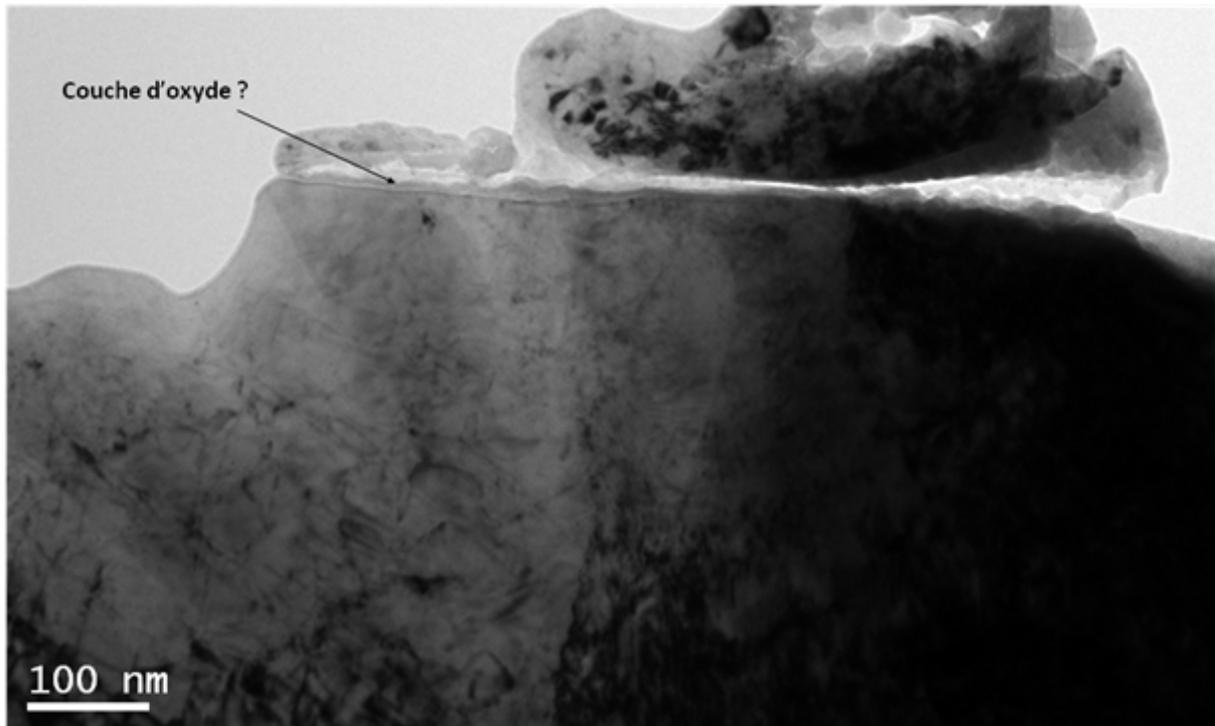
Figure 57 : Microscopie électronique à transmission (champ clair) de l'échantillon 304L brut préparé par amincissement ionique classique
