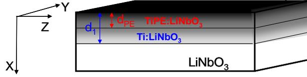
Figure 3.18 Guide d'onde planaire PPE-Ti:LiNbO<sub>3</sub>
