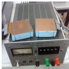
Figure 4-2 : Générateur de courant et « plans chauds »
