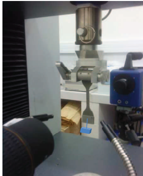
Figure 4-4 a: Chargement mécanique : poids suspendu
