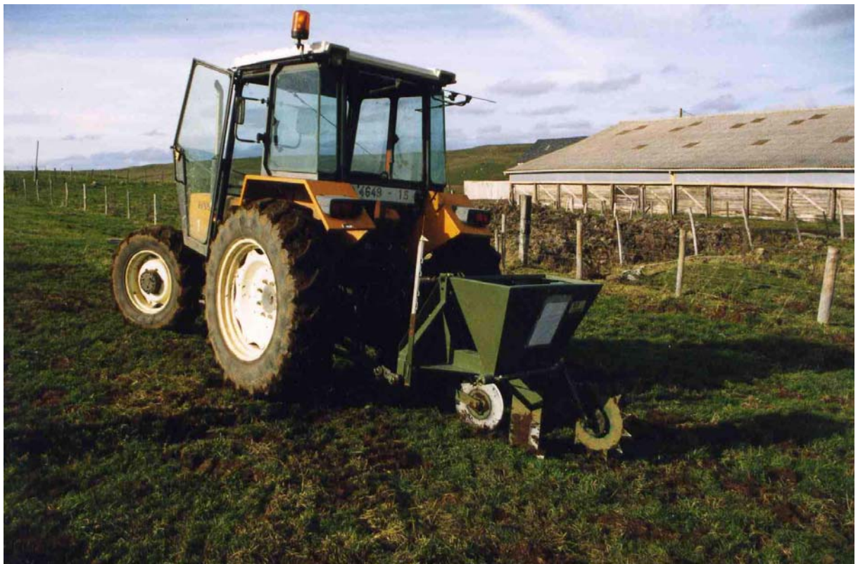
Fig 24 : bromadiolone (a) distribuée sur du blé par une charrue sous-soleuse (b), dans des galeries artificielles
